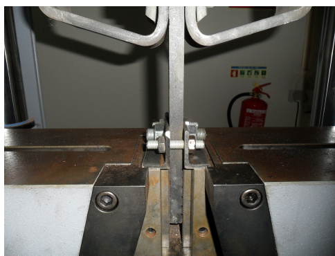
Figura 3.31: Cantoneiras aparafusadas à barra inferior para eliminar escorregamentos na maxila inferior da máquina
