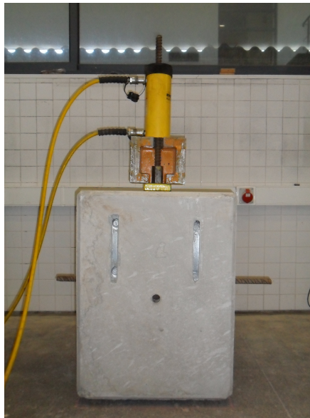
Figura 3.6: Aplicação do pré-esforço no varão do bloco de betão
