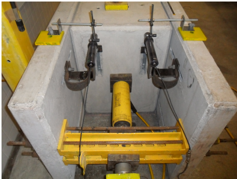
Figura 3.17: Posicionamento dos transdutores de deslocamento CDP-100
