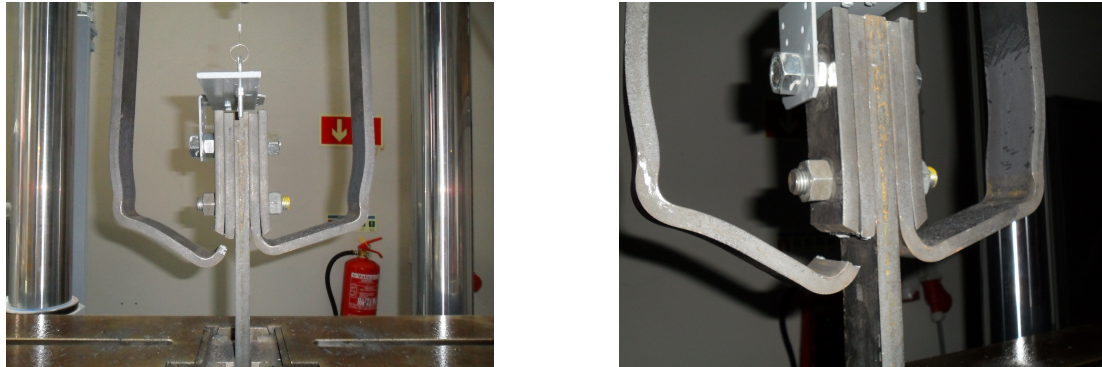
Figura 4.53: Rotura do dispositivo do lado esquerdo do modelo
