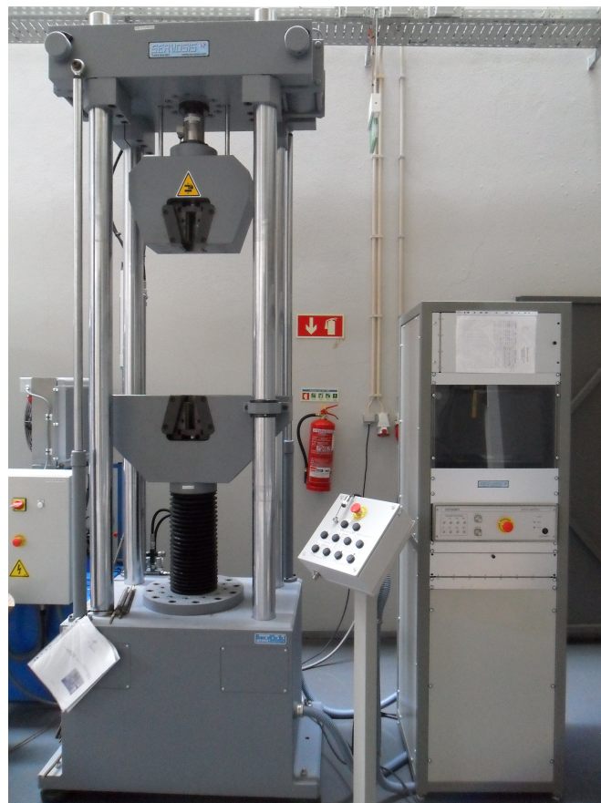
Figura 3.32: Máquina de ensaios Servosis ME 408/60 e respectivo sistema de aquisição de dados (direita)
