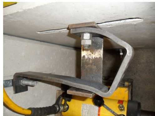
Figura 4.14: Ligação com os DR 50x10-1 na posição de deslocamento máximo positivo
