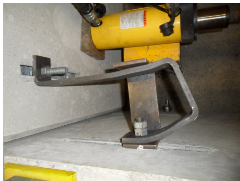
Figura 4.14: Ligação com os DR 50x10-1 na posição de deslocamento máximo positivo
