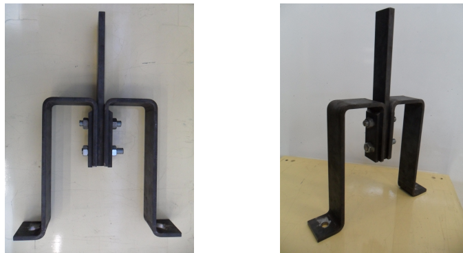
Figura 3.24: Modelo de ensaio dos dispositivos DR 70x10-1 e DR 70x10-2
