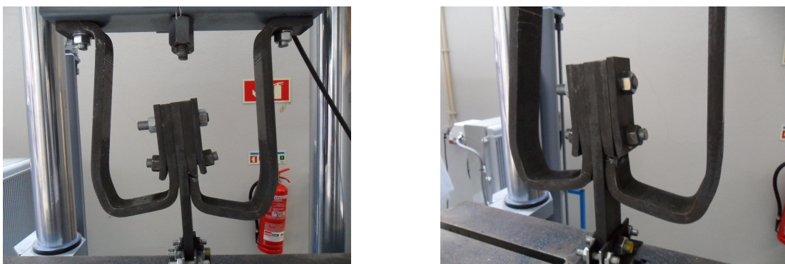
Figura 4.56: Rotura do dispositivo do lado direito do modelo e encurvadura do varão inferior da ligação
