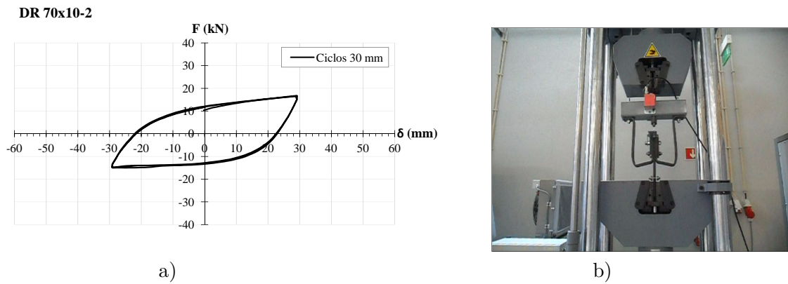
Figura 4.36: a) Diagrama força - deslocamento dos ciclos de 30 mm no modelo de DR 70x10-2, b) Deformada dos dispositivos para deslocamento máximo negativo nos ciclos de 30 mm
