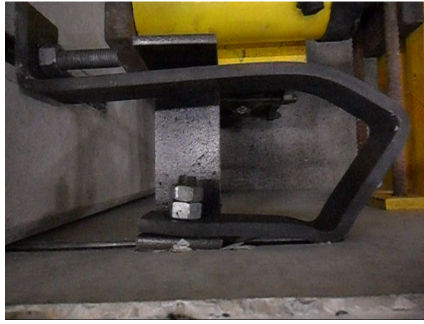
Figura 4.15: Ligação com os DR 50x10-1 na posição de deslocamento máximo negativo
