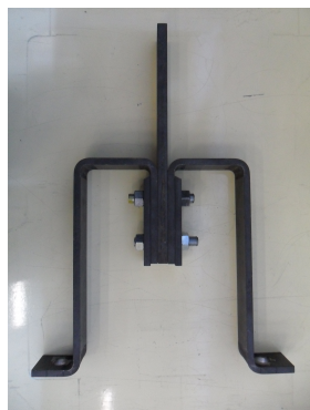
Figura 3.22: Modelo de ensaio dos dispositivos DR 50x10-2
