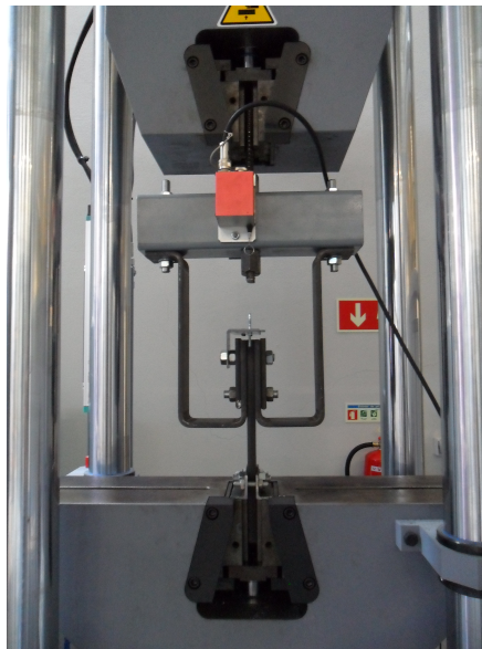
Figura 3.29: Sistema de ensaio com o modelo DR 70x10-2
