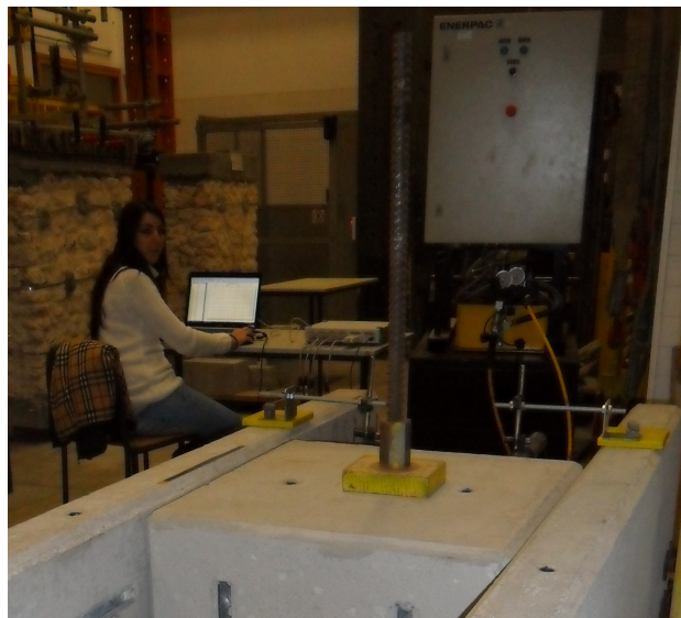
Figura 3.19: Vista geral do sistema de ensaio com o Datalogger Spider 8, computador portátil e Bomba hidráulica - Enerpac GPEW 2020 WSN (direita)
