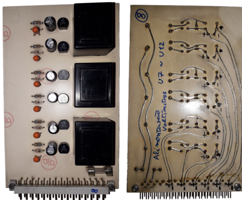
Figura 3.9: Fotografia da placa nº 8 do chassis 2, que contém as fontes que alimentam um conjunto de voltímetros. Lado esquerdo: plano frontal, lado direito: plano traseiro.
