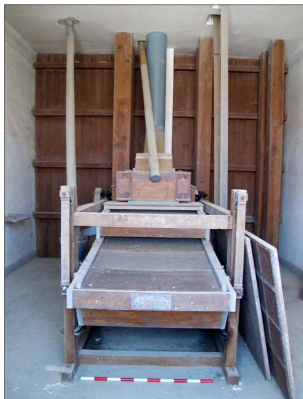
FIGS. 6 E 7 – Em cima, uma das máquinas integradas no laboratório, para replicação do descasque de arroz em ambiente laboratorial, após os trabalhos de limpeza, inventariação e catalogação.
