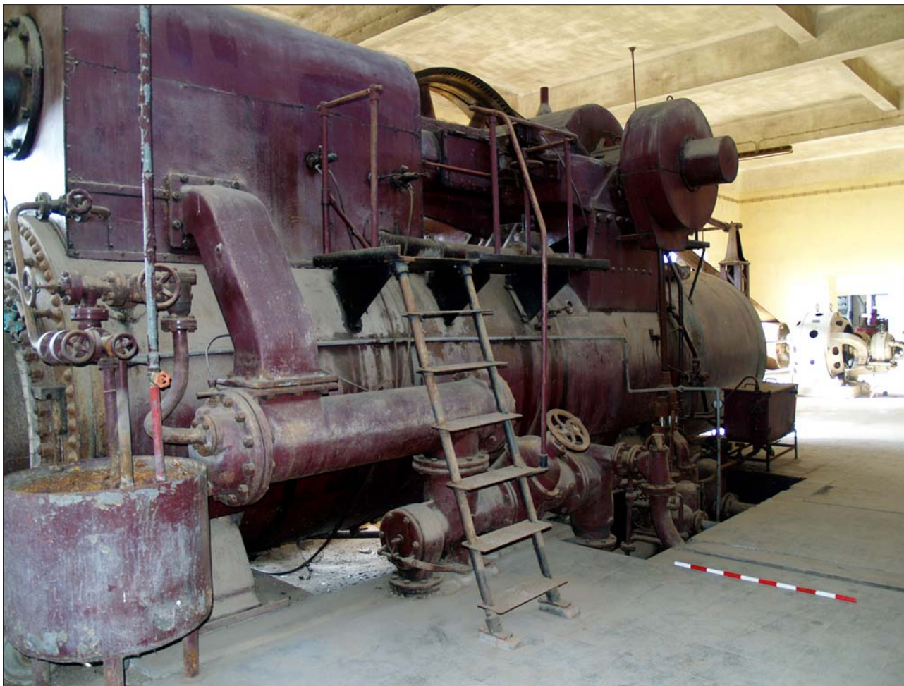
FIG. 10 – Vista parcial da máquina a vapor, vendo-se ao fundo, à direita, o gerador elétrico associado.
