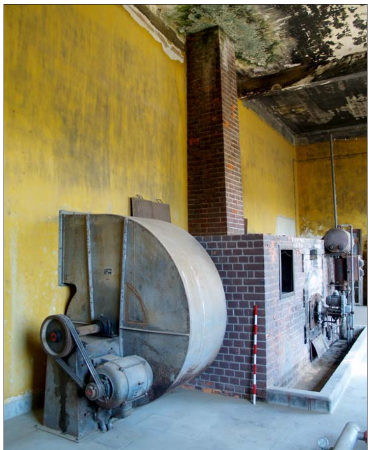
FIG. 5 – Vista da caldeira e ciclones para produção do ar aquecido e sua emissão para os secadores de arroz, que estariam situados na sala imediatamente por detrás da parede.
