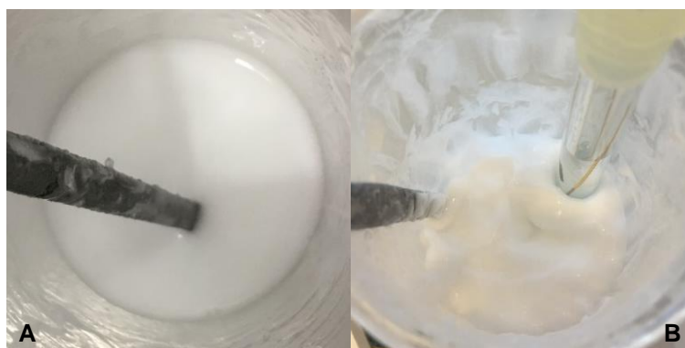
Figura 4.6 – A: Gel antes de adicionar neutralizante; B: Gel após a adição de neutralizante.
