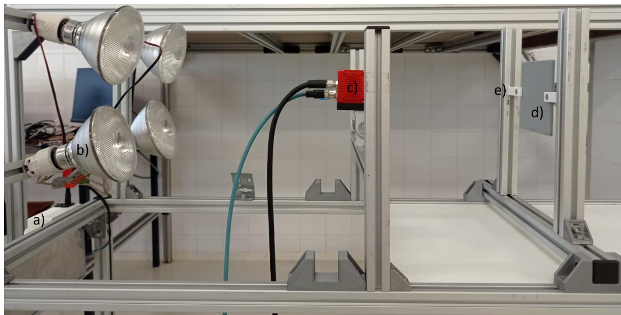
Figura 3.4 - Montagem experimental. a) Sistema para automatização do ensaio; b) Lâmpada Philips PAR38 IR; c) Câmara termográfica IRS336 da Automation Technology ; d) Provete; e) Suporte.
