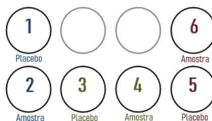
Figura 14 – Esquema da distribuição das amostras e do placebo pelos diferentes copos do aparelho de dissolução. Cada cor representa um meio de dissolução diferente sendo que existe uma amostra (granulado da formulação dos comprimidos produzidos) e um placebo em cada meio de dissolução. Legenda: Azul – Ácido clorídrico 0,1N pH 1,2; Verde – Tampão pH 4,5; Vermelho – Tampão pH 6,8.
