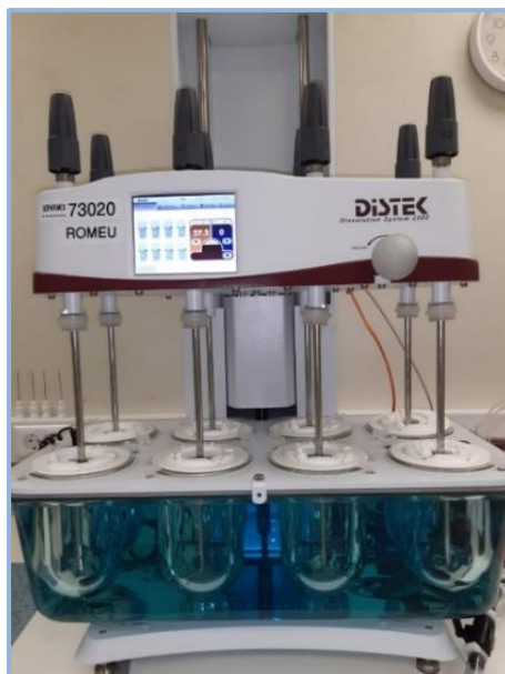
Figura 12 – Dissolutor Distek da empresa Sofarimex. O dissolutor utilizado nos ensaios desta tese é um dissolutor de pás que tem acoplado um doseador o qual facilita a extração das amostras nos diferentes tempos.
