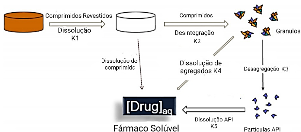
Figura 9 – Representação dos passos que podem existir aquando da dissolução de um medicamento sólido. Cada passo de dissolução está associado a uma constante (k) e consoante as diferentes classes de medicamentos estes vão necessitar de um dado número de passos para se obter o princípio ativo dissolvido no meio de dissolução (Retirado e adaptado de “Zaborenko, N. et al. First-Principles and Empirical Approaches to Predicting In Vitro Dissolution for Pharmaceutical Formulation and Process Development and for Product Release Testing. AAPS Journal 21, (2019)”).
