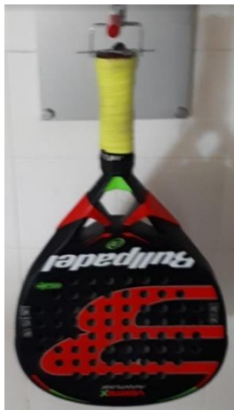
Figura 2.13- Montagem determinação J_{xx}
