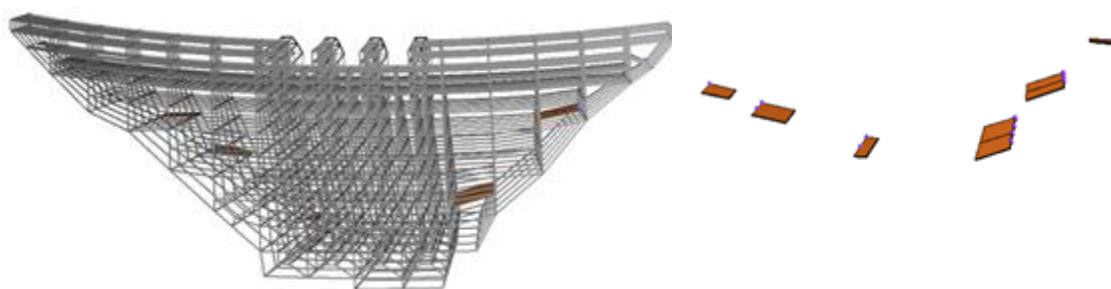
a) Elementos de interface betão/betão no corpo da barragem (elementos com dano assinalados a castanho) b) Elementos de interface com valores de dano no corpo da barragem
