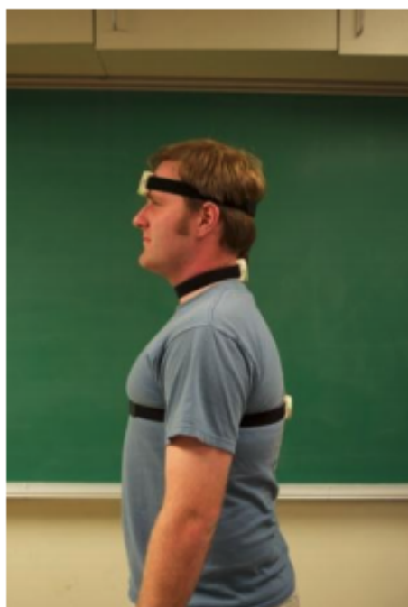
Figura 2.9: Posição dos sensores na proposta de Taeyoung Kim [31]
