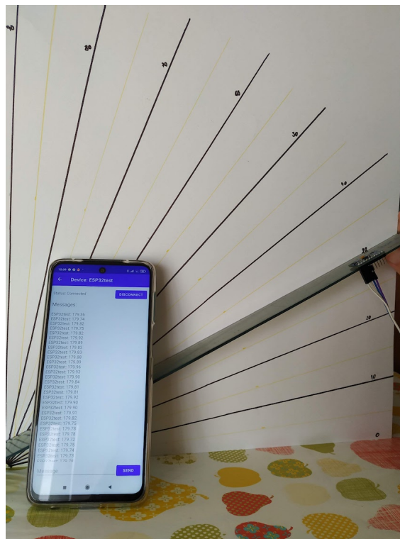
Figura 4.4: Teste do sensor comparando com um transferidor
