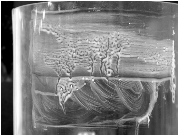
Figura 3.9 – Fotografia do resultado de um ensaio realizado com querosene na parede da câmara.
