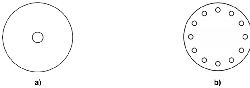
Figura 1.1 – Configuração de injectores: a) jacto central único; b) arranjo anelar de jactos.
