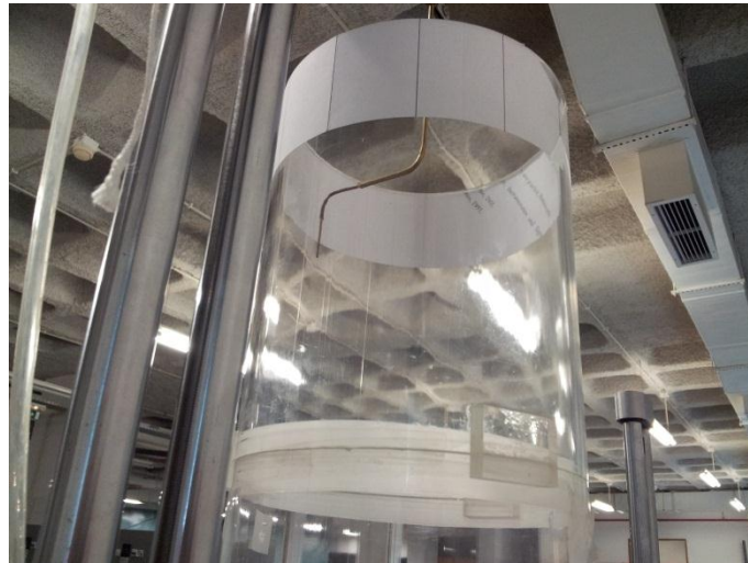
Figura 2.19 – Fotografia do pormenor da marcação das posições tangenciais.
