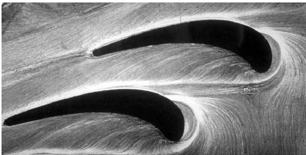
Figura 1.14 – Visualização com filme de óleo do escoamento junto a uma pá de uma turbina (Havermann et al. 2002).
