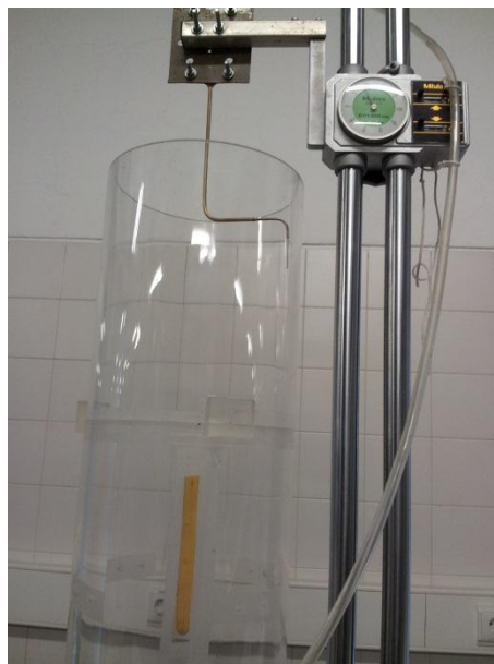
Figura 2.18 – Fotografia do tubo de Pitot em S montado próximo da saída da câmara.
