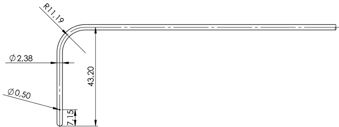
Figura 2.15 – Representação esquemática das dimensões principais da sonda de pressão estática.
