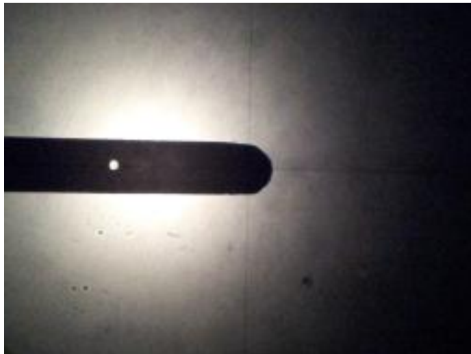
Figura 2.13 – Fotografia da sonda de pressão estática colocada num projector de perfis. Resultado final.
