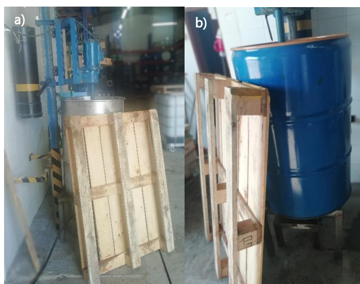
Figura 3.2 - Etapa da dissolução do espessante E2 em água, a) na produção do lote L07, b) na produção do lote L09.
