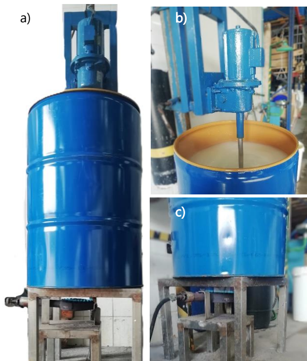
Figura 1.2 - Dissolução de um espessante em água morna, num bidão metálico com aquecimento e agitação intermédia. a) Sistema da preparação; b) Imagem do topo do bidão; c) Fogão com lume médio.
