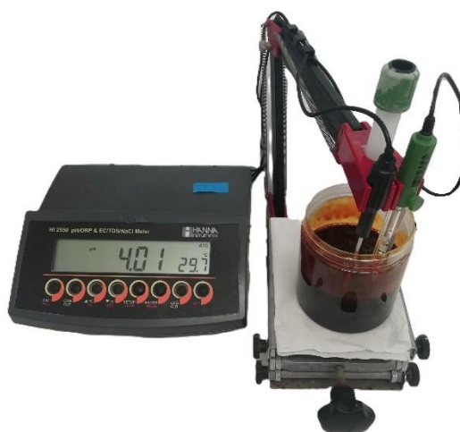
Figura 3.4 - Medição do pH de uma amostra do antisséptico iodado (QM01).
