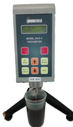
Figura 3.7 - Determinação da viscosidade do produto QM01.
