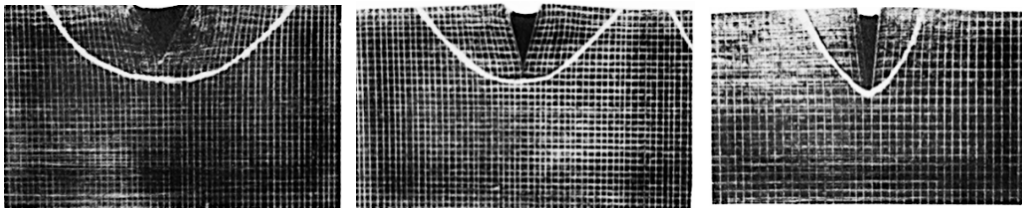
Figura 12 - Resultados experimentais (as linhas brancas representam uma aproximação da zona plástica)
