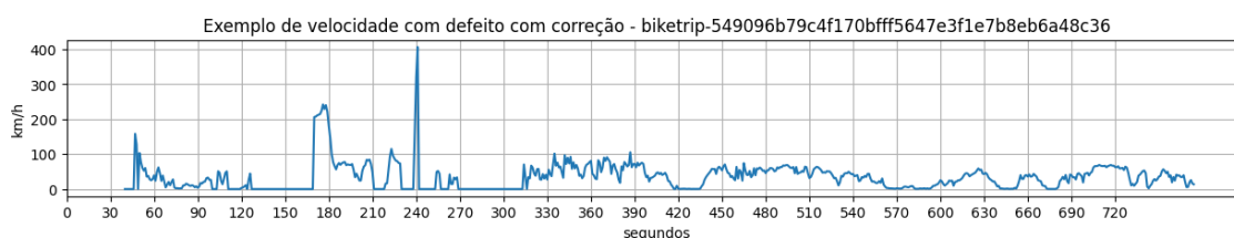
Figura 5.12: Exemplo de gráfico de velocidade com defeito tipo 1 no meio da viagem
