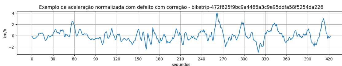
Figura 5.7: Exemplo de gráfico de aceleração normalizada com defeito tipo 2 com correção
