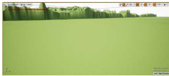
Figura 4.24: Demonstração do efeito de repetição do tiling das texturas.
