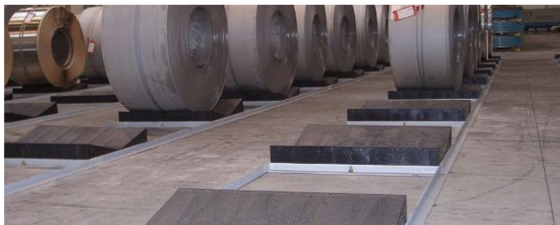
Figura 7.4 – Blocos de armazenamento em forma de berço da empresa Lankhorst [41]
