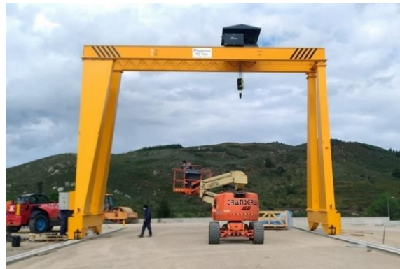
Figura 5.27 - Pórtico biviga da empresa Marco Vil [26]
