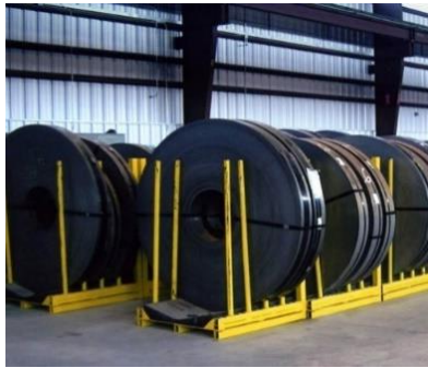
Figura 7.11- Armazenamento de bobinas de espessura reduzida modelo Mobile Slit Coil Rack [47]
