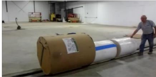
Figura 5.17- Transportador de bobinas manual da empresa MHSA [18]
