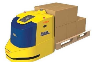
Figura 5.4-AGV preparado para transportar paletes [9]
