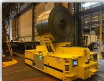
Figura 5.7 -Veículos Guiados Automaticamente da empresa IrwinCar [8]
