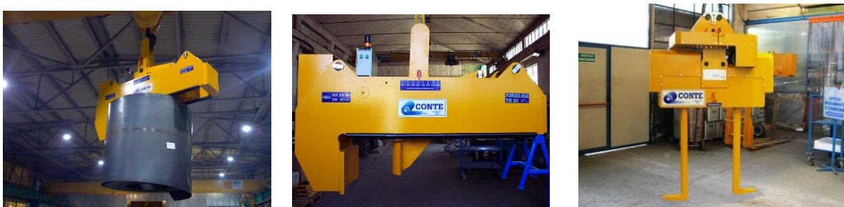
Figura 6.11 Acessórios de transporte de bobinas com o seu eixo na vertical da empresa Conte [36]
