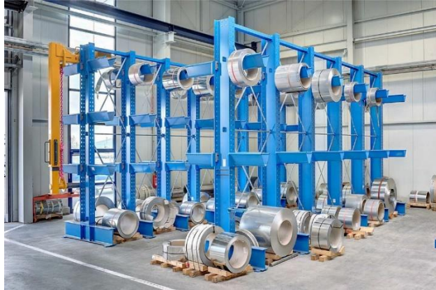
Figura 7.18 - Armazenamento de estantes através de vigas da empresa OHRA [52]
