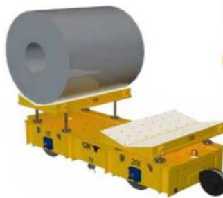
Figura 5.1 - AGV com deslocamento através de rodas [7]
