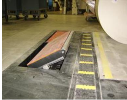
Figura 5.18- Empurrador fixo da empresa C&M Conveyor [19]
