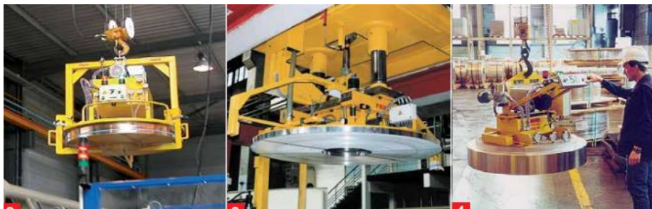
Figura 5.30- Mecanismo de transporte através de vácuo [28]
