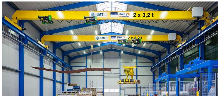
Figura 5.24 - Ponte rolante univiga da empresa STAHL [25]
