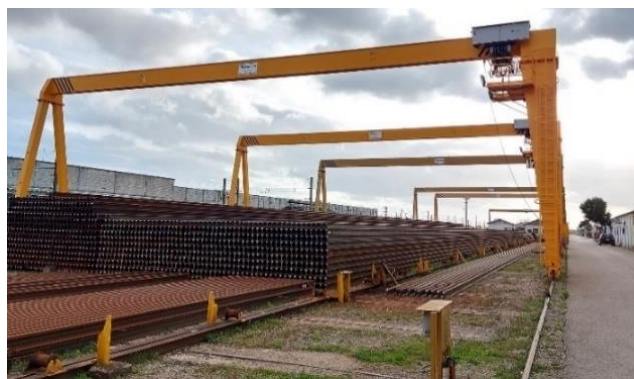
Figura 5.28 - Pórtico univiga da empresa Marco Vil [26]
