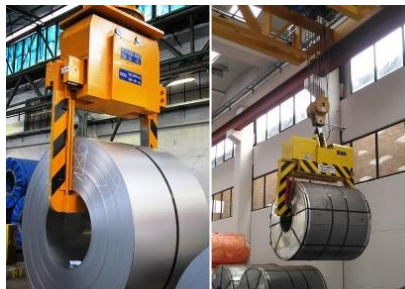
Figura 6.9 - Mecanismo de duplo gancho da empresa Conte [36]
