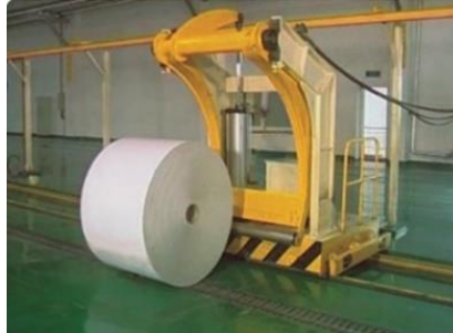
Figura 5.22 - Empurrador misto da empresa Sinolion [23]
