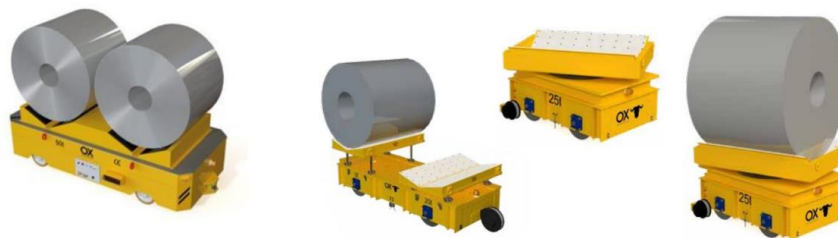
Figura 5.6 - Veículos Guiados Automaticamente da empresa OX WorldWide [7]
