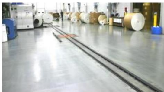
Figura 5.16- Transportador de bobinas manual da empresa C&M Conveyor [17]
