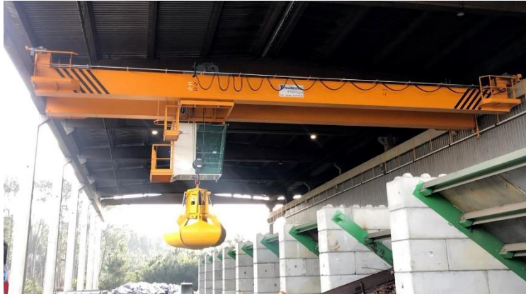
Figura 5.25 - Ponte biviga da empresa Marco Vil [24]
