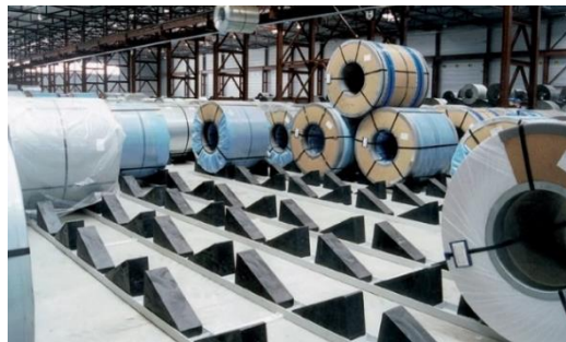
Figura 7.8- Sistema de calços modelo Roll Blocks da empresa Lankhorst [45]
