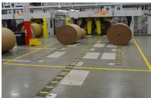
Figura 5.15- Transportador de bobinas com motor da empresa C&M Conveyor [16]
