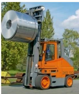
Figura 5.13 - Empilhador Hubtex Roxx [14]
