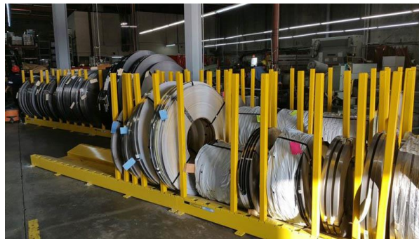
Figura 7.10- Armazenamento de bobinas de espessura reduzida modelo Steel Floor Slit Coils [47]
