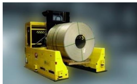
Figura 5.3- AGV preparado para transportar bobinas pelo eixo central [10]
