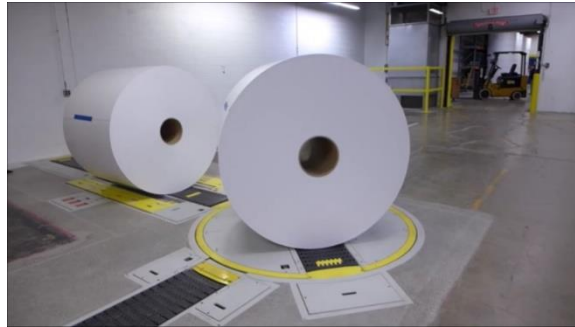
Figura 6.2 - Sistema de rotação com motor da empresa Metal Handling Sales Associates [30]
