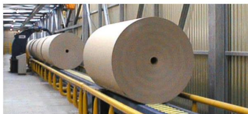
Figura 5.14 - Transportador de bobinas com motor da empresa SICMA [15]
