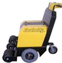
Figura 5.21- Empurrador móvel da empresa DJProducts [22]
