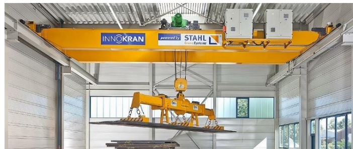
Figura 5.26 - Ponte biviga da empresa STAHL [25]
