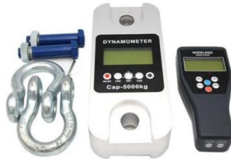
Figura 4.2 - Dinamómetro da empresa Galocce [4]
