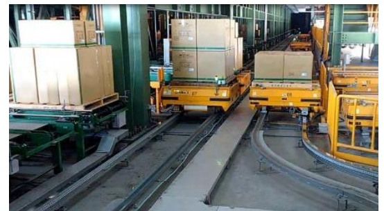
Figura 5.2 - AGV com deslocamento através de um rail [8]
