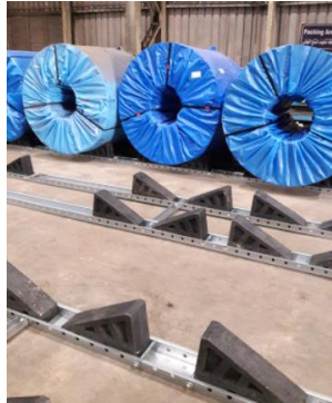
Figura 7.9- Sistema de calços modelo Roll Blocks da empresa Profil Kunststoff Technik [46]
