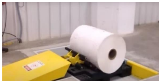
Figura 5.19 - Empurrador fixo da empresa Harmax [20]
