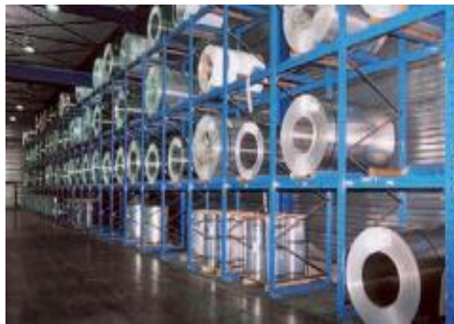
Figura 7.17 - Armazenamento em estante da empresa OHRA [51]
