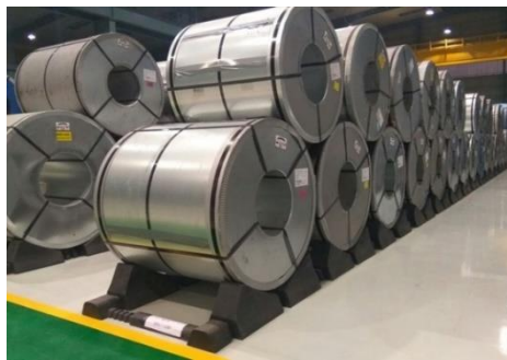
Figura 7.7 - Sistema de calços modelo Roll Stop System [44]
