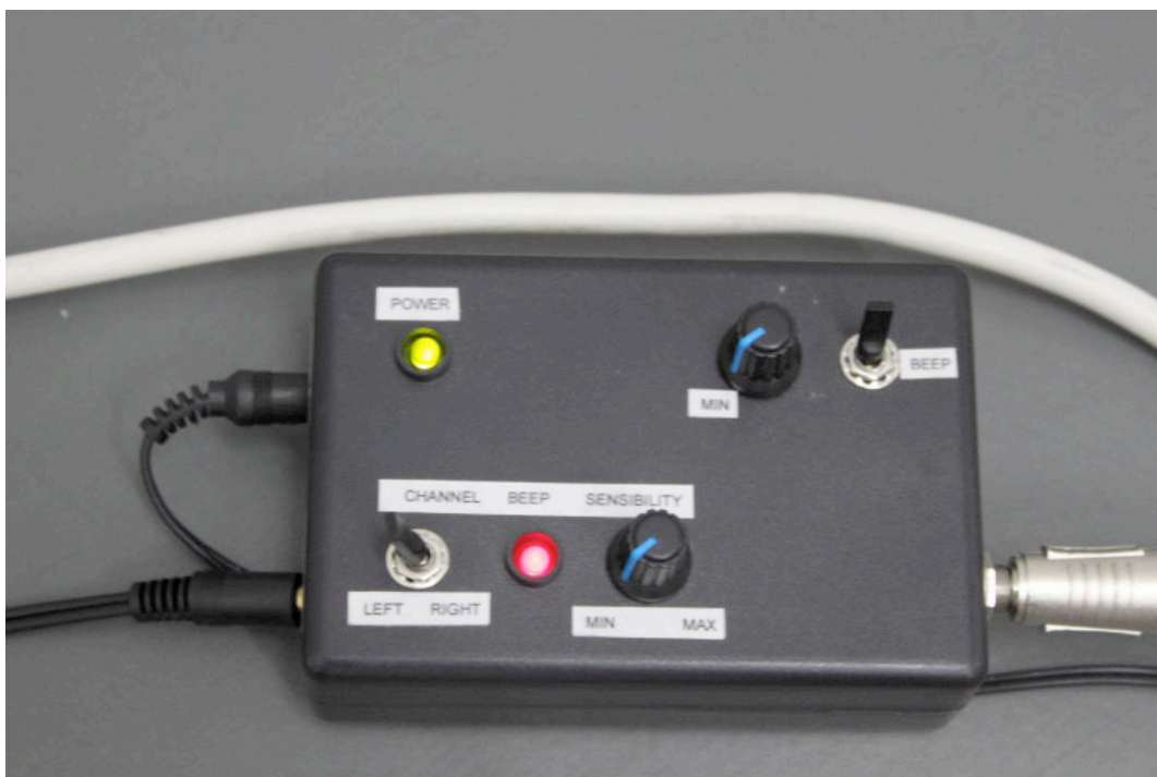
Fig. 70 - Dispositivo de Sincronização e Controlo de Libertação de Fumo. (ligado)
