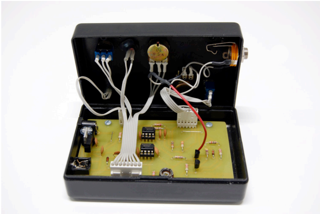
Fig. 72 - Dispositivo de Sincronização e Controlo de Libertação de Fumo.
