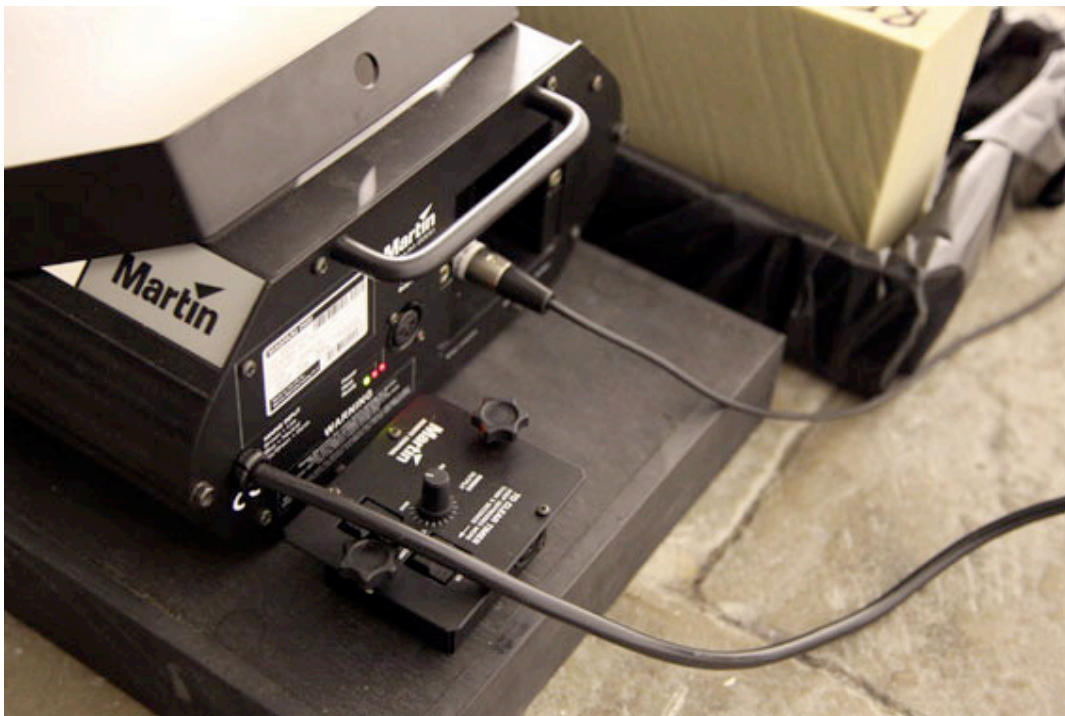
Fig. 108 - Máquina de fumo Martin Jem 2000 na Tate Liverpool (detalhe da entrada de áudio / controlo remoto).
