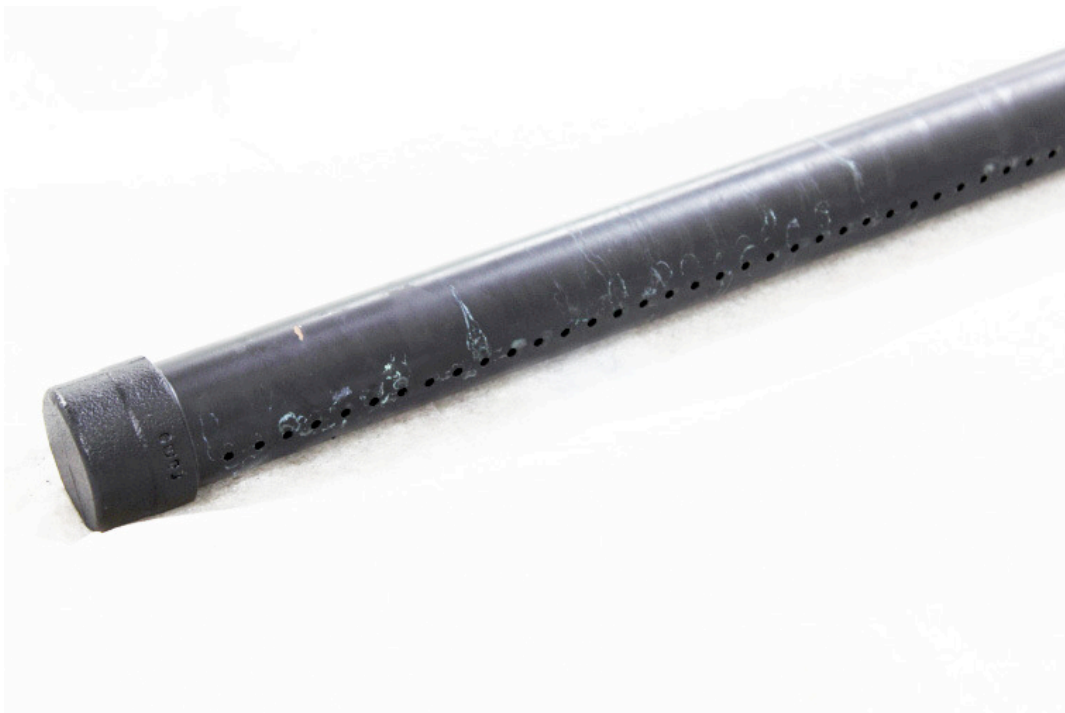
Fig. 91 - Detalhe tubo "T". (furos para a saída de fumo).
