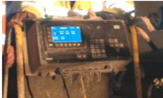
Figura 2.28 – Aparelho Logac, para medição, registo de caudal e pressão das injeções de
