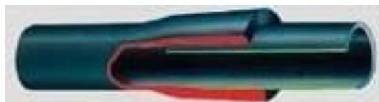
Figura 2.15 – Pormenor do encaixe das estacas dúcteis
