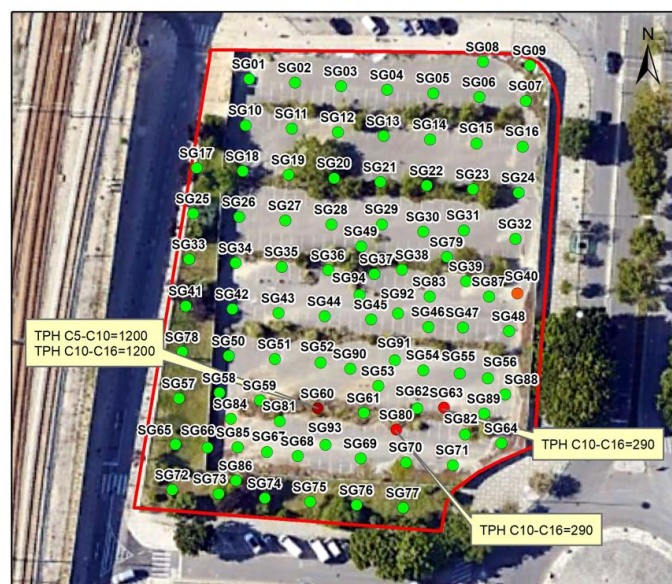
TPH - Nível B (mg/kg) ● Não foi analisado TPH C5-C10 ● Teores inferiores aos valores de referência ● Teores superiores aos valores de referência para TPH C10-C16 ● Teores superiores aos valores de referência para TPH C5-C16 □ Área de estudo 0 10 20 Metros
