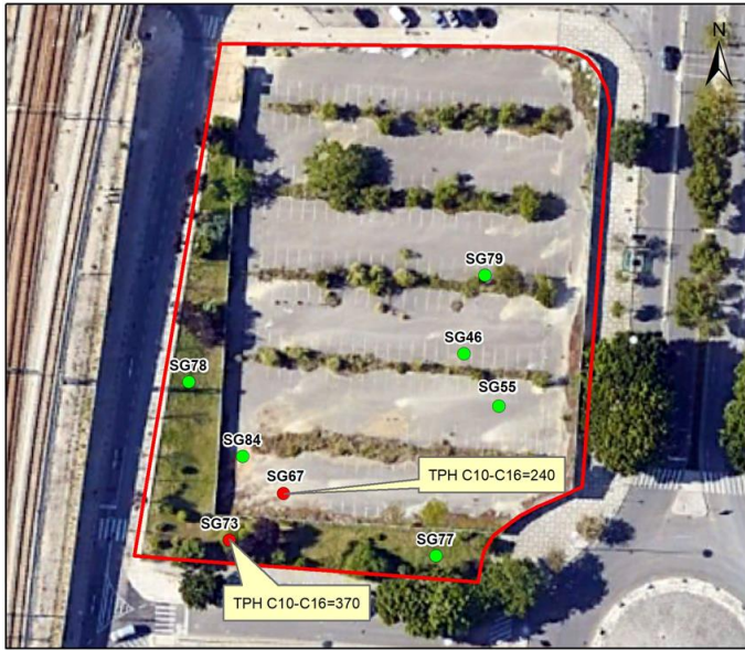
TPH - Nível K (mg/kg) ● Teores inferiores aos valores de referência ● Teores superiores aos valores de referência para TPH C10-C16 □ Área de estudo 0 10 20 Metros
