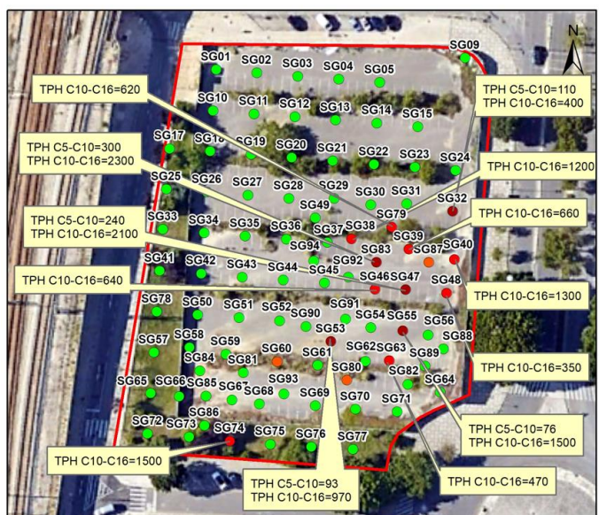
TPH - Nível E (mg/kg) ● Não foi analisado TPH C5-C10 ● Teores inferiores aos valores de referência ● Teores superiores aos valores de referência para TPH C10-C16 ● Teores superiores aos valores de referência para TPH C5-C16 0 10 20 Metros □ Área de estudo
