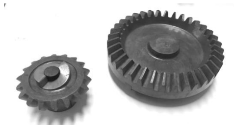
Figura 2. 5 - Exemplo de modelos de fundição em madeira, cedidas por cortesia da MDF, Lda.
