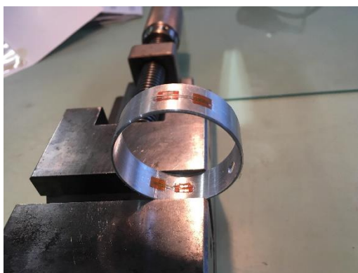
Figura 3. 35 - Anel com extensómetros colados
