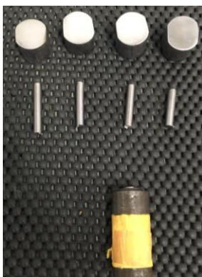
Figura 3. 43 - Amostras e pinos para ensaio de desgaste
