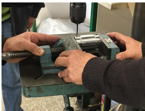
Figura 3. 33 - Furação do anel de alumínio
