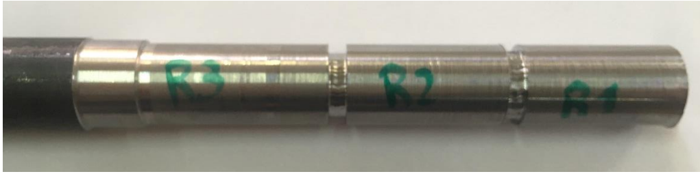
Figura 3. 8 - Zonas R1, R2 e R3 para teste de parâmetros de corte
