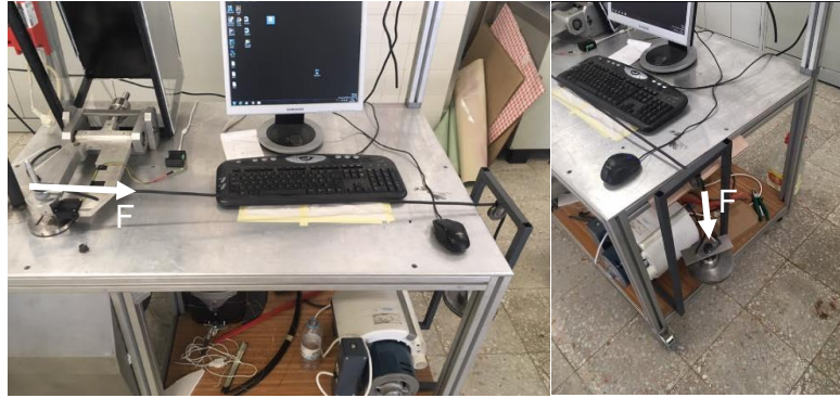
Figura 3. 41 - Aplicação de força para calibração
