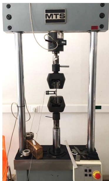
Figura 3. 27 - Provete montado no equipamento com extensómetro
