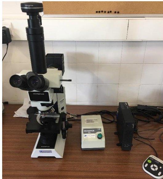
Figura 3. 19 - Microscópio OLYMPUS CX40 , com câmara digital OLYMPUS DP21 e regulador de luminosidade OLYMPUS TH3
