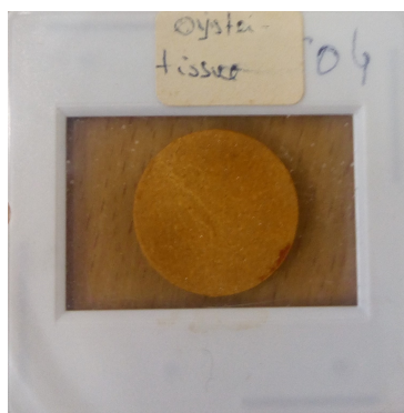
Figura 4.2: Fotografia da pastilha de Oyster Tissue SRM 1566 utilizada.
