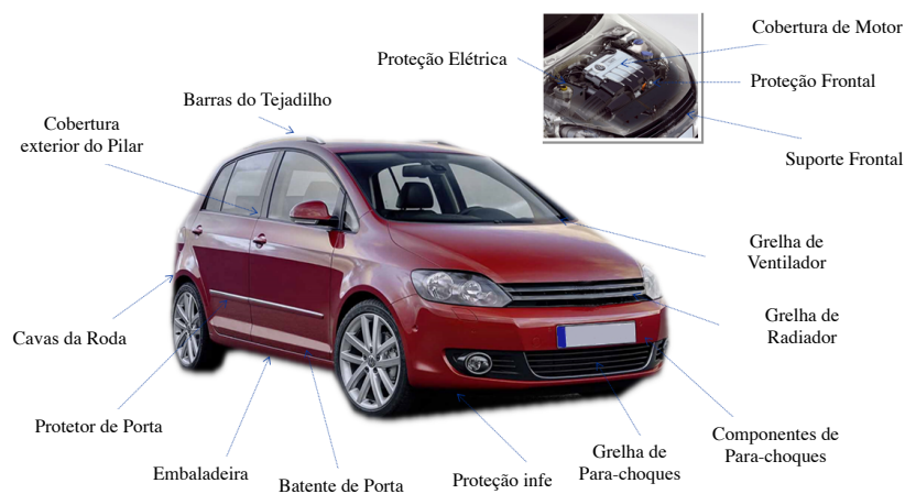
Figura 3. 2 - Peças plásticas do exterior de um automóvel produzidas no grupo Simoldes (Simoldes, 2017)
