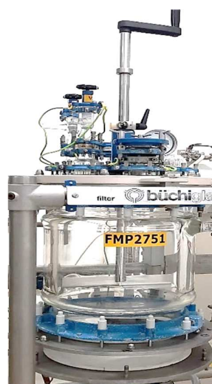
Figura 3.6 - Filtro Nutsche com agitação mecânica: FMP2751.
