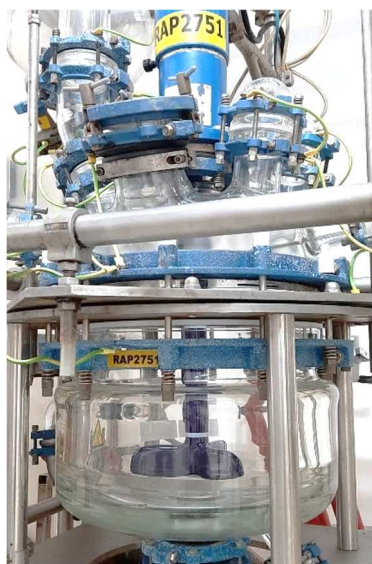
Figura 3.5 - Reator de 20L de vidro, equipado com uma hélice: RAP2751.
