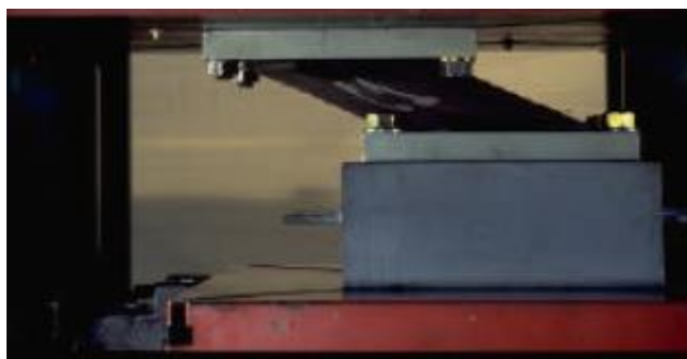
Figura 2.9 – Deformação horizontal de um apoio HDRB (Santos, 2008)
