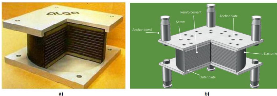
Figura 2.8 – Estrutura interna de um apoio de borracha de alto amortecimento e seu esquema (Freyssinet, 2020)
