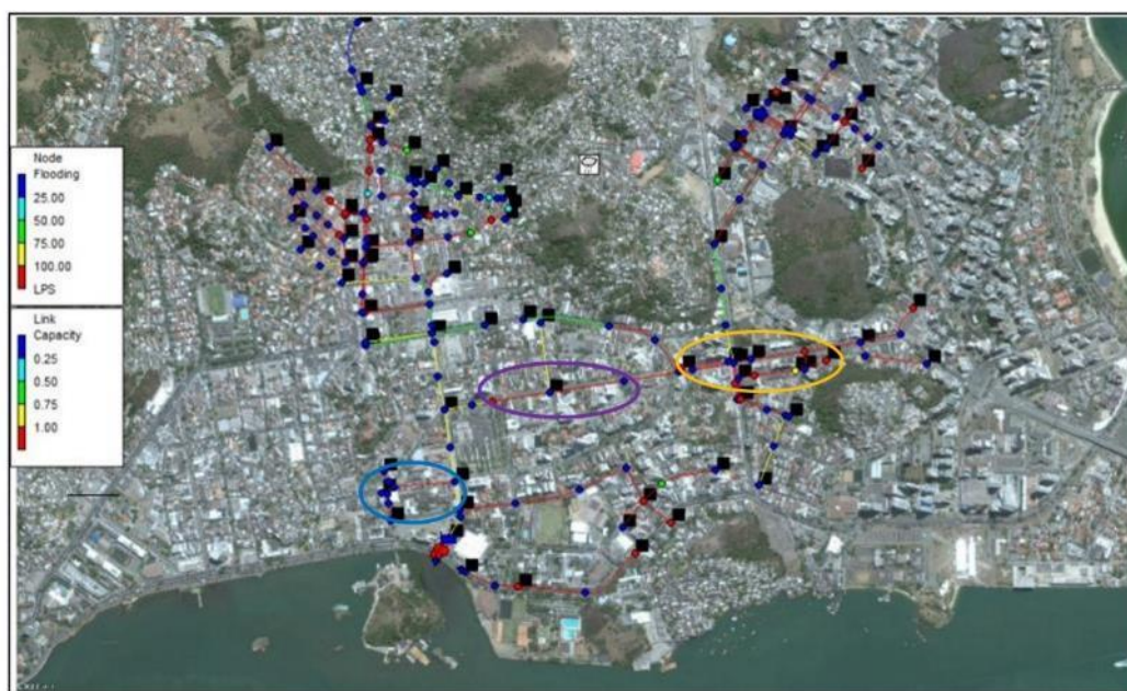
Figura 6-8: Simulação SWMM para o bairro de Bento Ferreira no momento crítico de chuva (coletores em carga) para o período de retorno de 50 anos.
