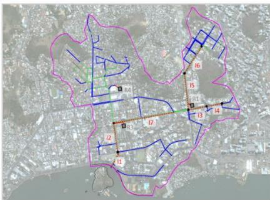
Figura 6-3: Opções de solução nº1 (A) e nº 2 (B) proposta pelo PDDU. A opção nº2 substitui o reservatório R2 pelo coletor adicional (17). As caixas em cinza indicam a localização dos reservatórios enterrados e em vermelho a proposta de construção de reservatórios adicionais.
