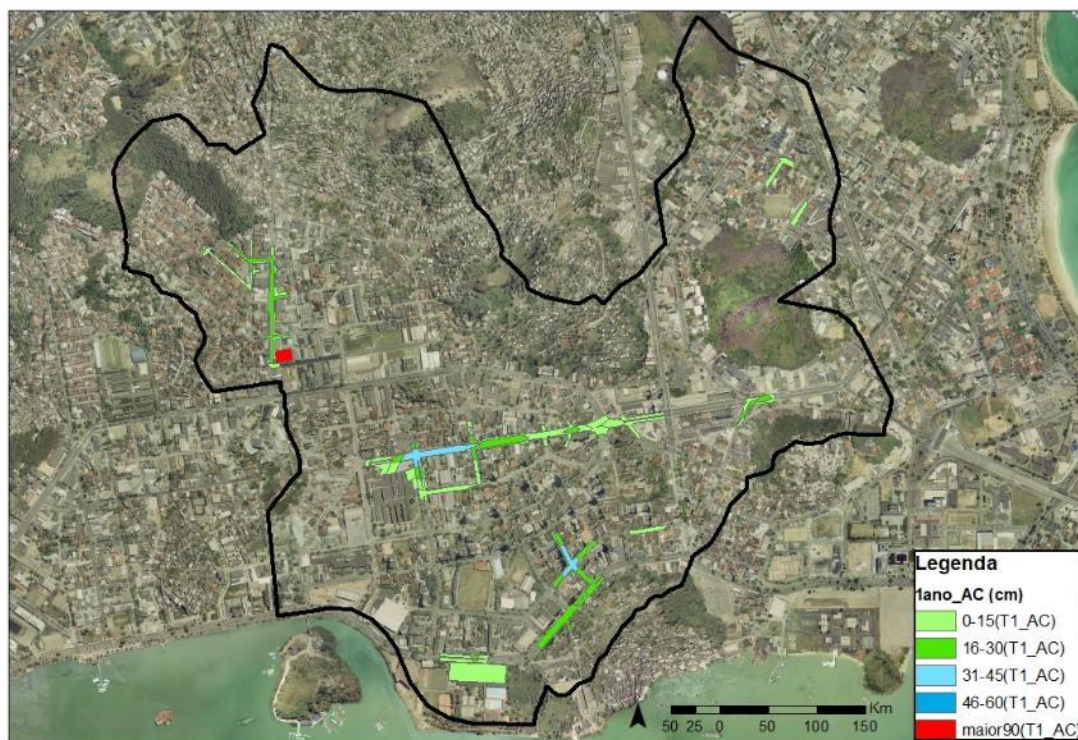
Figura 6-10: Áreas de inundação no bairro Bento Ferreira com o acréscimo das alterações climáticas, para o período de retorno de 1 ano.
