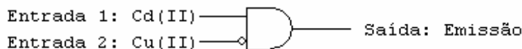
Figura 6.22: Diagramas lógicos do sistema lógico constituído pelo composto A2222L usando como sinais de entrada os iões Zn(II) e Cu(II), o pH como sinal de selecção da função lógica, e como sinal de saída a emissão a 420 nm.
