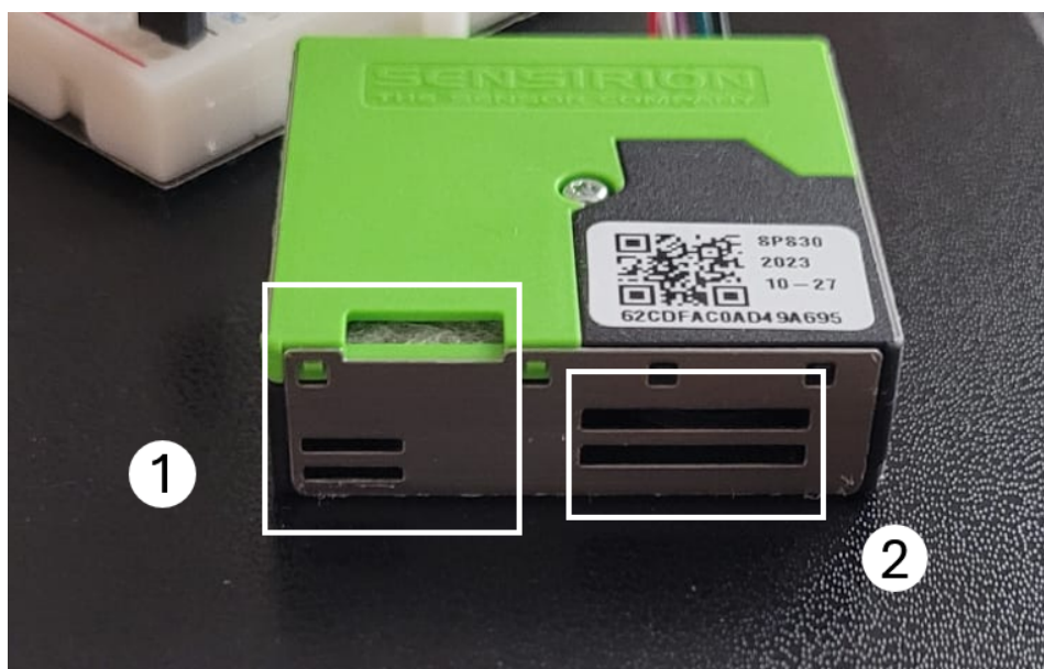
Figura 3.8: Representação das entradas (1) e saídas (2) do fluxo de ar do sensor.
