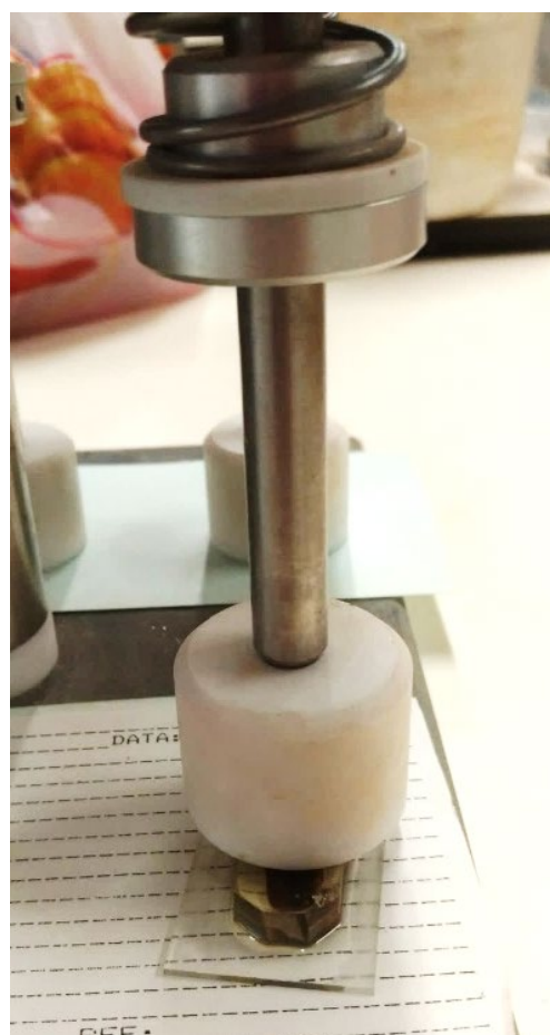
Figura 5.4: Secção transversal polida e impregnada sobre a lâmina de vidro na prensa.
