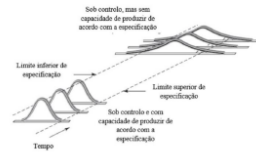
Figura 1 – Influência da variabilidade na capacidade do processo
