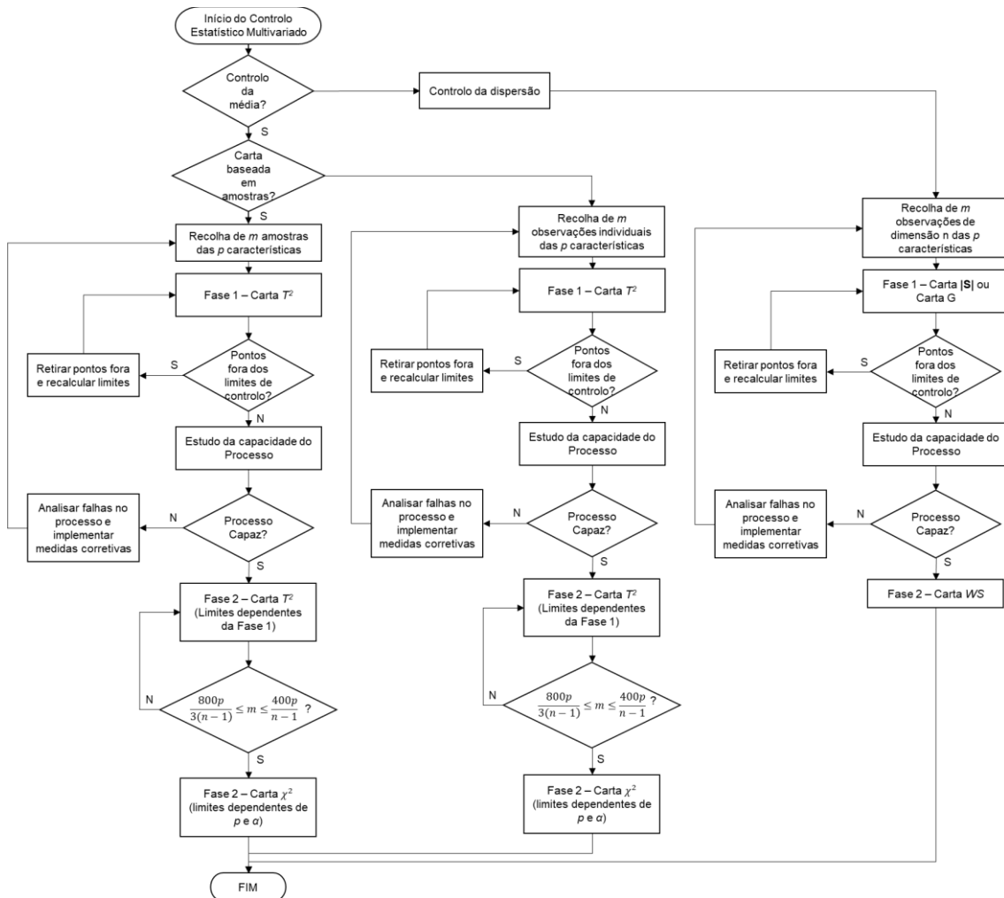
Figura 2.5 - Metodologia para implementação do Controle Estatístico Multivariado do Processo (MSPC)
