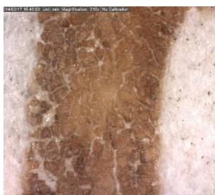
Figura III.12 - Tinta ferrogálica. Luz Vis. 215x
