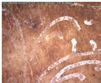
Figura III.12 - Tinta ferrogálica. Luz Vis. 215x
