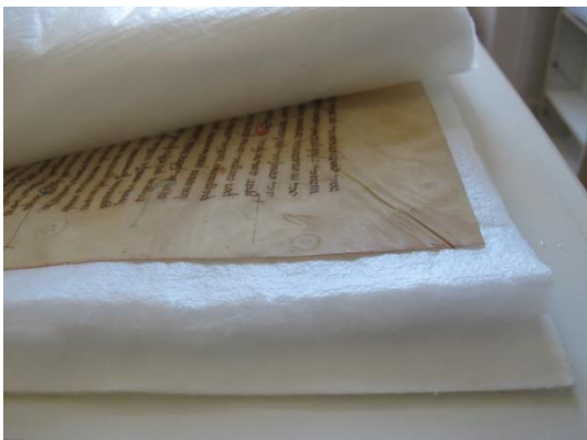
Figura VI.11 - Humificação dos bifólios com mata-borrão e simpatex
