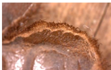
Figura III.4 – Rasgão no couro Luz Vis 45x
