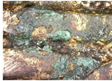
Figura III.7 - Produtos de corrosão 215x
