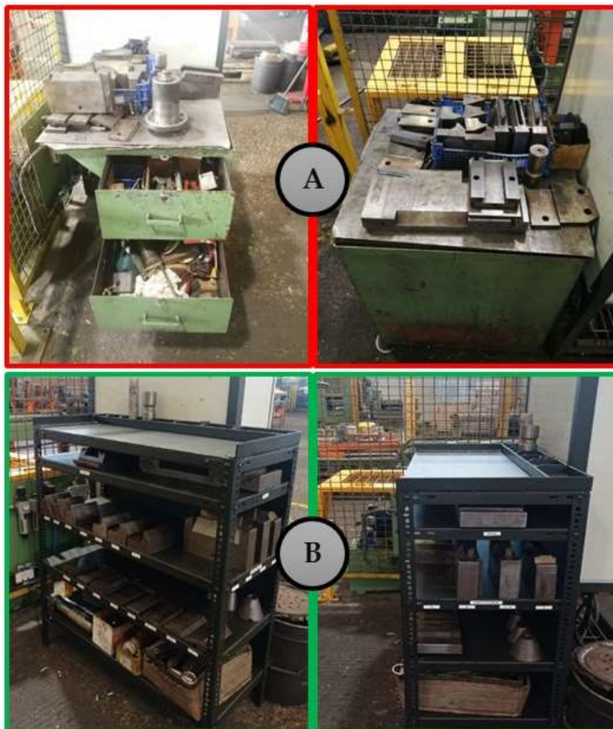
Figura 5-12 – Fase de organização na bancada de ferramentas: (A) Antes e (B) Depois
