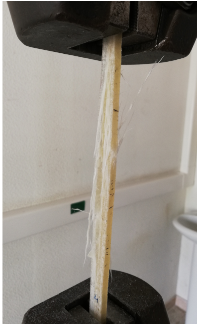
Figura 3.14: Fratura de um provete com sequência de empilhamento B
