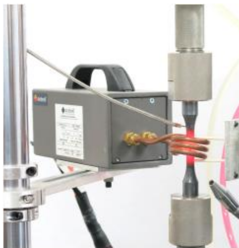
Figura 3.6 - Mecanismo de aquecimento por indução térmica [20].
