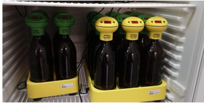
Figura 3.7 Determinação da CBO 5 com Oxitop
