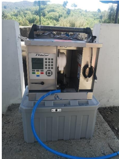
Anexo 6 Amostrador da WaterSam ® utilizado na recolha de amostras horárias de caudal
