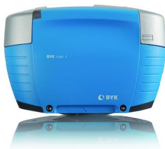
Figura 2.10 – Espectrofotómetro multi-ângulo BYK-mac i [17]
