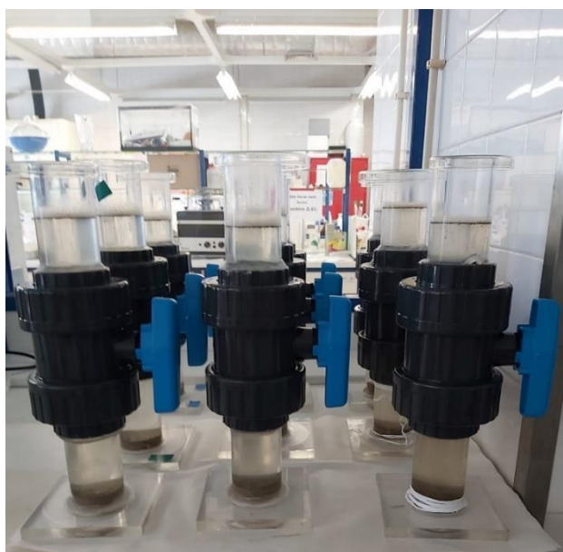
Figura 3.5. Sistema para isolamento de microplásticos (SMI) - permite uma rápida decantação das partículas que são separadas do sedimento pelo fecho da válvula. Material: tubo acrílico, válvula PVC (Coppock et al., 2017).
