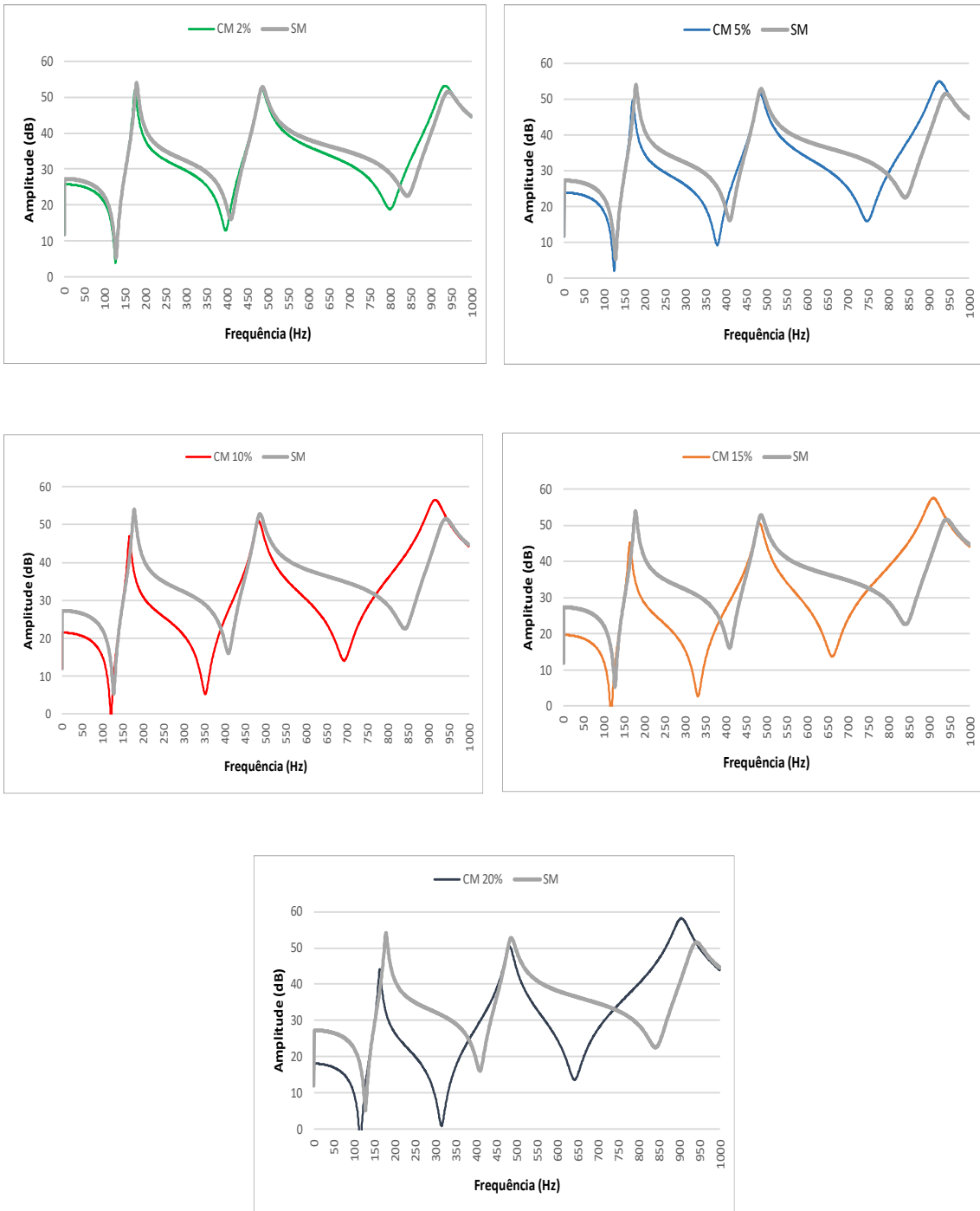
Figura 5.2- Gráficos das FRFs diretas H1,1 correspondentes aos casos sem dano e com dano de severidade 2%, 5%, 10%, 15% e 20% para a simulação com o elemento finito de casca
