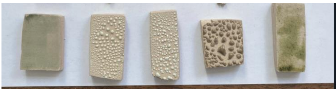
Figura A.5.2 – Amostras 5%SS cru, 5%Basalto, 5% Xisto, 5% SS, 5%Basalto fundido (por ordem da esquerda para a direita) utilizando a pincelagem como técnica de revestimento
