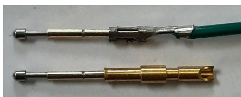
Figura 3.6 - Conexão das pontas aos cabos de ligação. Utilizando um terminal tipo "jumper" fêmea, em cima e utilizando um conector fêmea Bulgin SA3347/1, em baixo.
