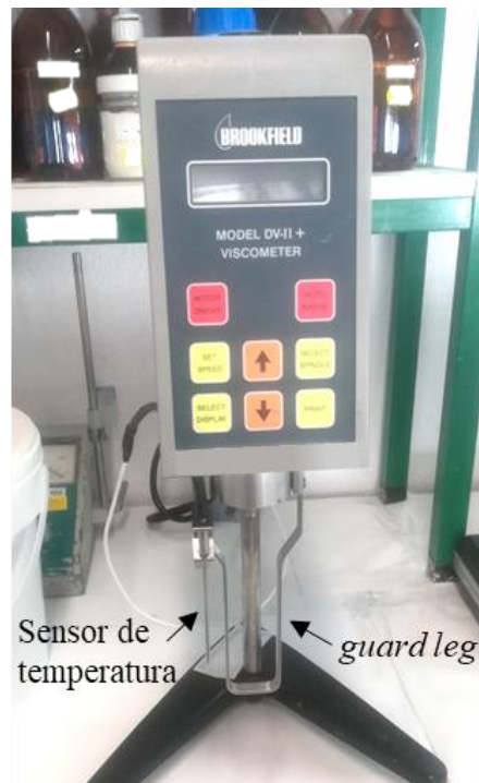
Figura 2.7 - Viscosímetro rotativo Brookfield com guard leg e sensor de temperatura.
