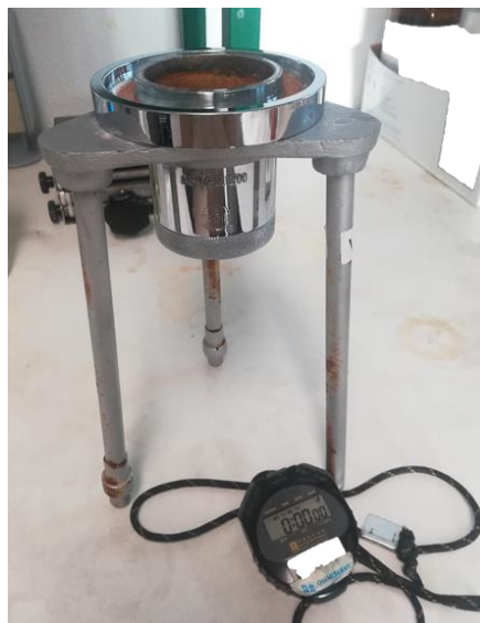
Figura 2.6 - Copo Ford nº4 com diâmetro de 4,12 mm e cronómetro.
