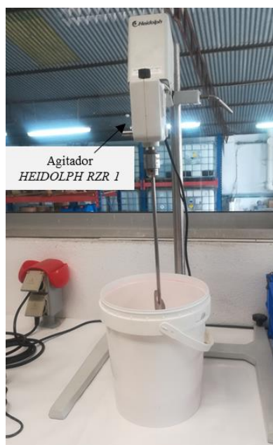
Figura 3.1 - Balde de 5 L posicionado debaixo do agitador HEIDOLPH RZR 1 , pronto para a produção do CG02/21.
