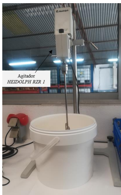
Figura 3.2 - Balde de 10 L posicionado debaixo do agitador HEIDOLPH RZR 1 , pronto para a produção do CG06/21.
