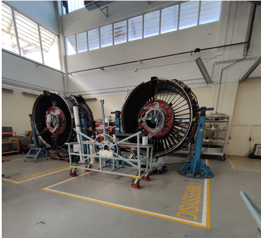
Figura 4.3: Área de Remoção/Instalação de LEAP-1A
