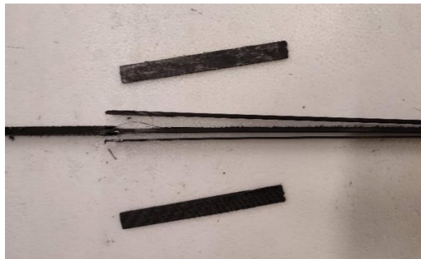
Figura 58. Pormenor da rotura do provete 3(A)
