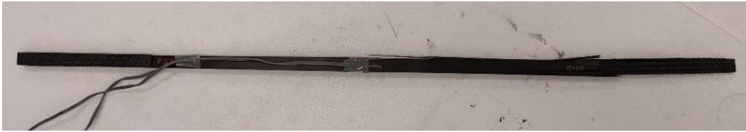
Figura 39. Rotura do provete 2(A)
