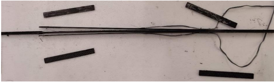
Figura 57. Rotura do provete 3(A)
