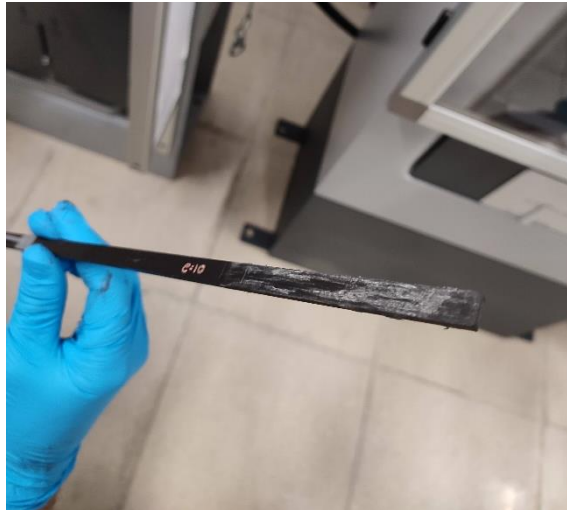
Figura 28. Provete sem proteção após ensaio
