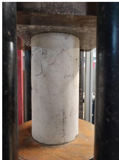
Figura 101. Rotura do provete cilíndrico à compressão
