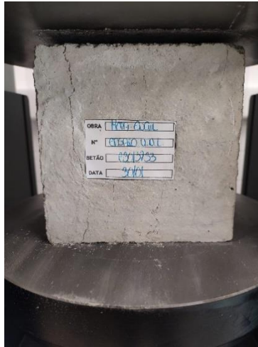
Figura 98. Rotura do provete cúbico à compressão
