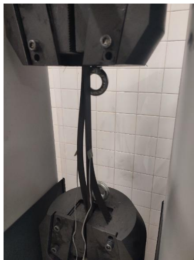
Figura 63. Rotura das layers do provete 3(C)
