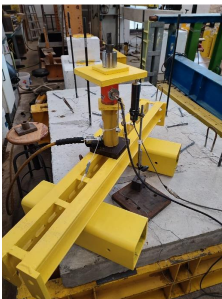
Figura 89. Configuração do ensaio de arrancamento
