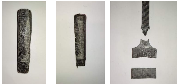
Figura 115. Rotura dos protótipos PC1, PC2 e PC3
