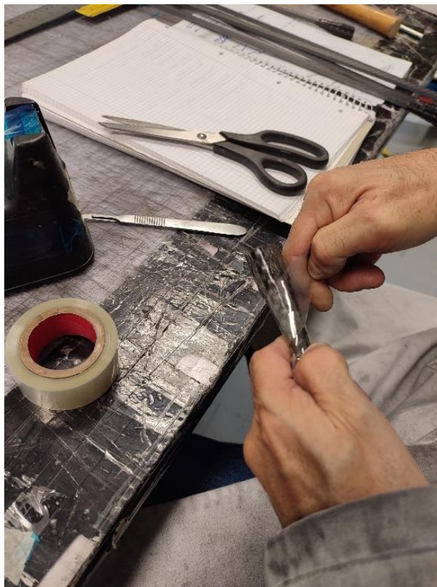
Figura 77. Aplicação da fita termoretrátil
