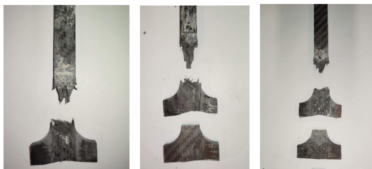
Figura 111. Rotura dos protótipos PB1, PB2 e PB3
