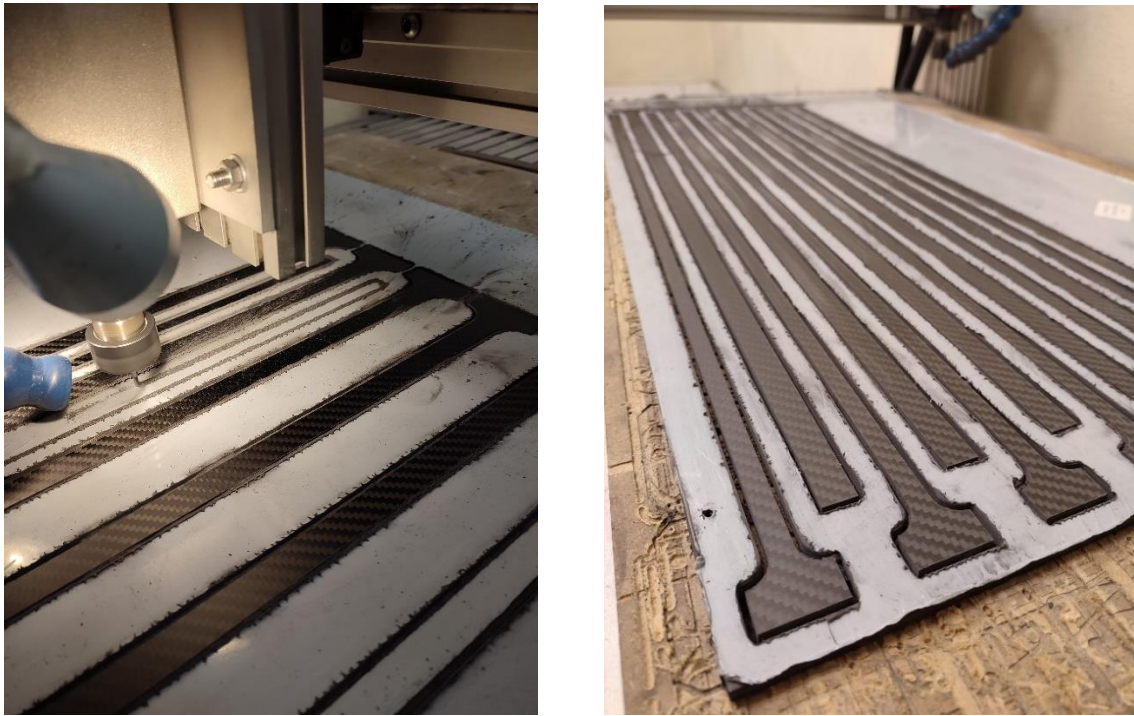
Figura 72. Corte do laminado 3, na CNC
