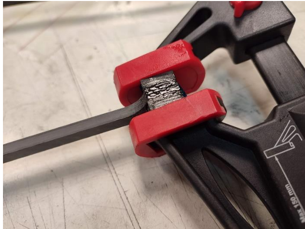
Figura 75. Fixação das pastilhas a um protótipo através de grampos
