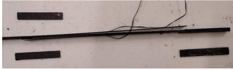
Figura 60. Rotura do provete 3(B)
