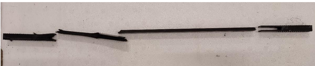
Figura 25. Rotura do provete 1 (B)
