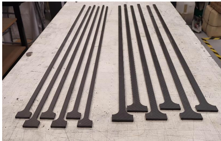
Figura 73. Protótipos tratados posteriormente ao corte na CNC
