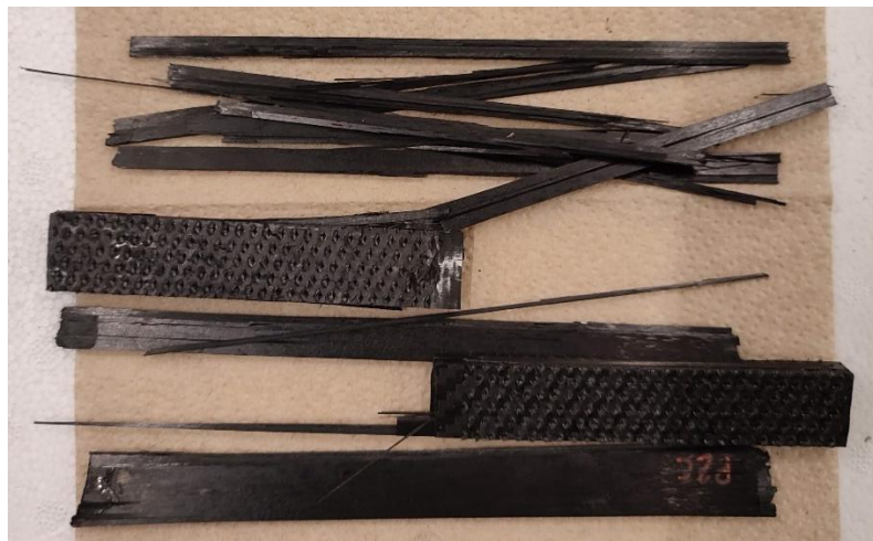
Figura 42. Rotura do provete 2 (C)
