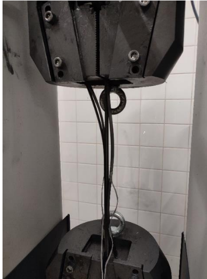
Figura 61. Rotura das layers do provete 3(B)
