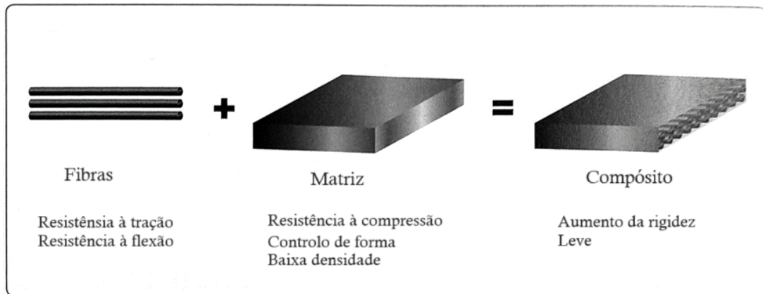
Figura 11. Composição de um laminado, adaptado de (Dorworth et al., 2019)
