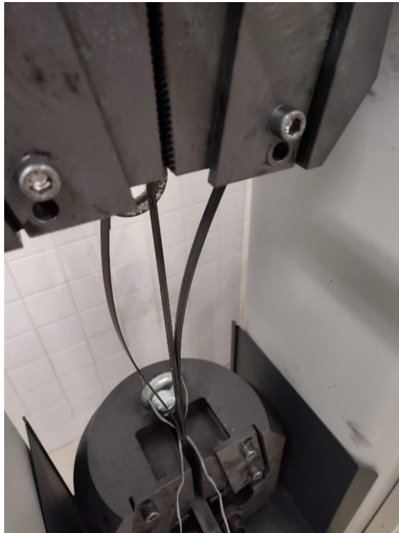
Figura 59. Rotura das layers do provete 3(A)
