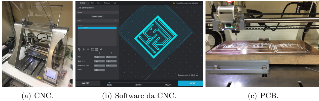
Figura 8.11: Desenvolvimento do circuito condicionador de sinais.
