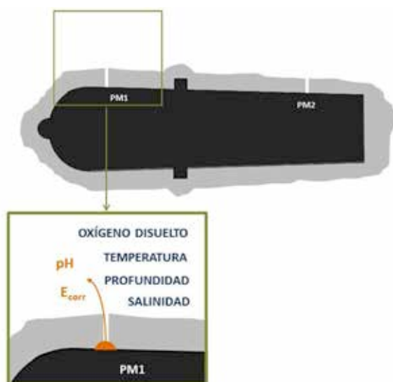
5. Diagrama de una pieza de artillería con los agujeros en los puntos de medición PM , y junto a los elementos a registrar del grupo entorno de los artefactos y superficie metálica del artefacto.
