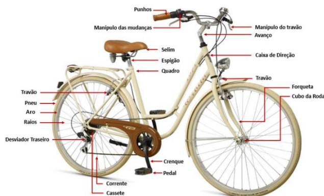
Figura 2.4 - Componentes de uma bicicleta [5]
