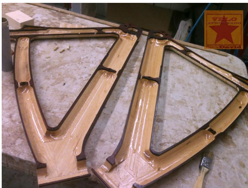
Figura 3.3 - Quadro da Renovo ainda por colar [21]
