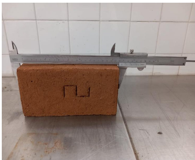
Figura 3.7 - Medição de um tijolo com craveira manual
