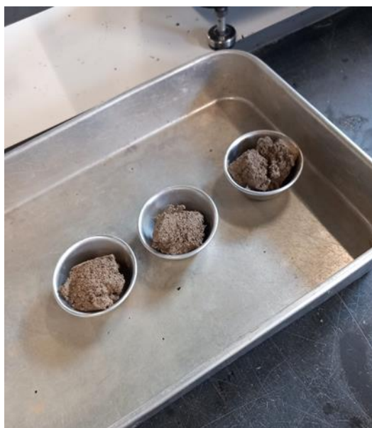
Figura 3.6 - Cápsulas com os provetes da amostra de mistura de terra e água para produção dos tijolos de controlo e dos adobes no telheiro
