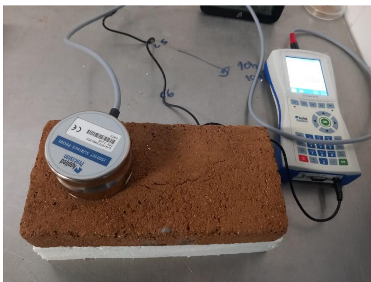
Figura 3.8 - Ensaio de condutibilidade térmica
