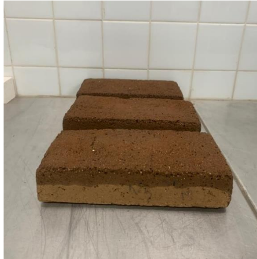
Figura 3.14 - Tijolos após serem imersos 60±2 segundos
