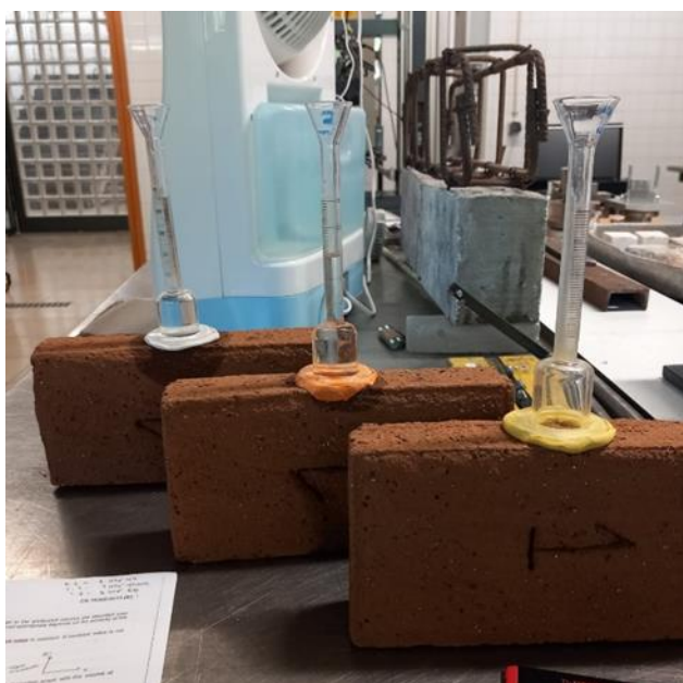
Figura 3.13 - Tubos de Karsten aplicados em unidades de alvenaria
