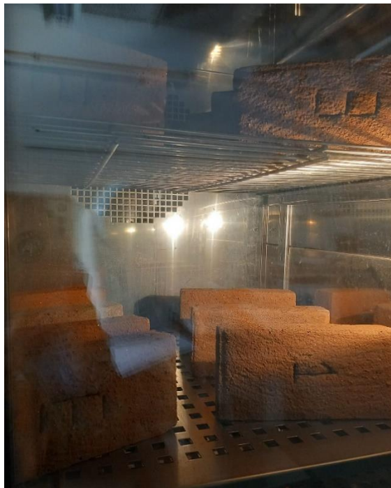
Figura 3.15 - Unidades de alvenaria na câmara climática
