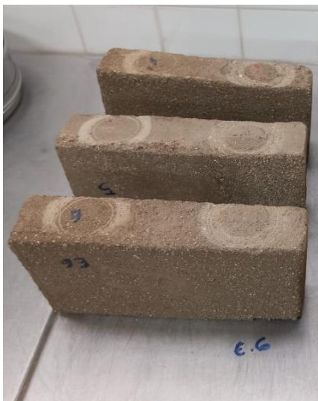
Figura 4.10 - Estado dos adobes após realização do ensaio de absorção de água a baixa pressão
