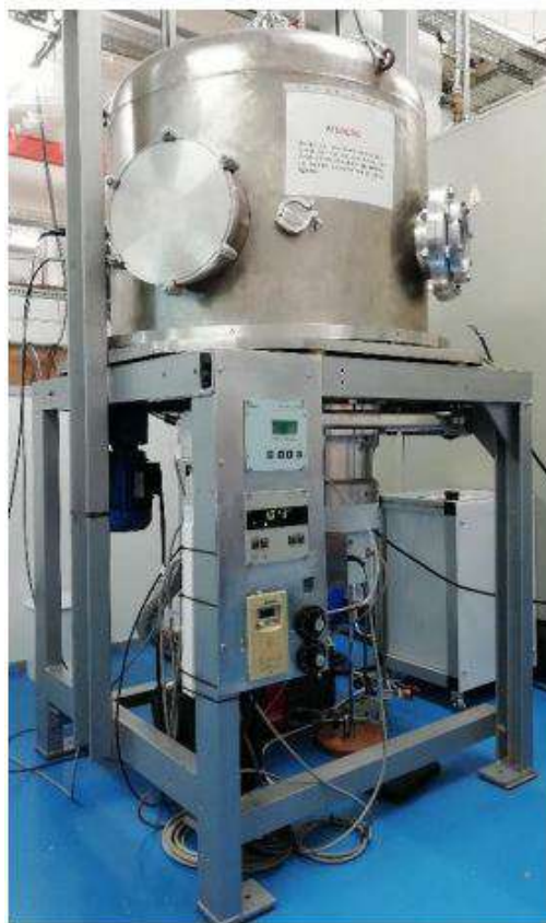
Figura 3.6: Equipamento de sputtering utilizado para a deposição de filmes finos. Retirado de [73].
