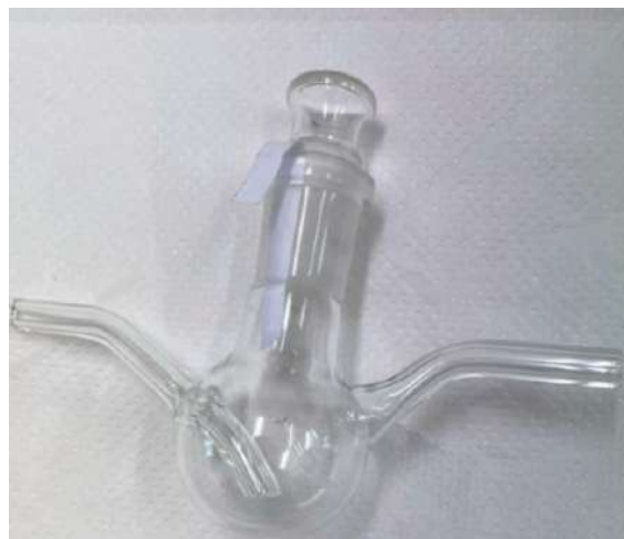
Figura 3.9: Balão de fundo redondo produzido na unidade de investigação VICARTE.
