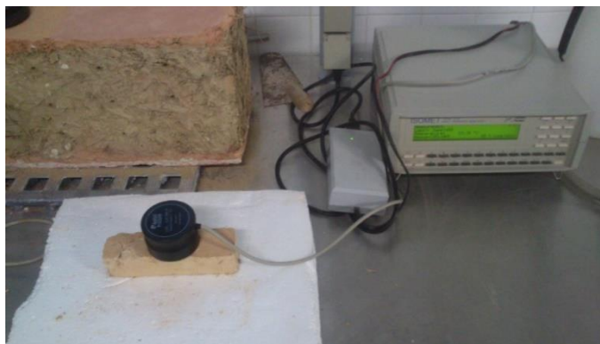
Figura 3.5 - Ensaio de condutibilidade térmica nos provetes 3 e equipamento ISOMET 2104
