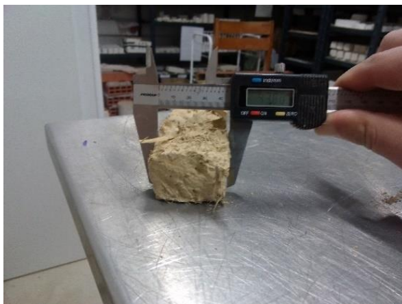
Figura 3.3 - Medição das dimensões dos provetes com recurso a craveira digital de precisão 0,01 mm
