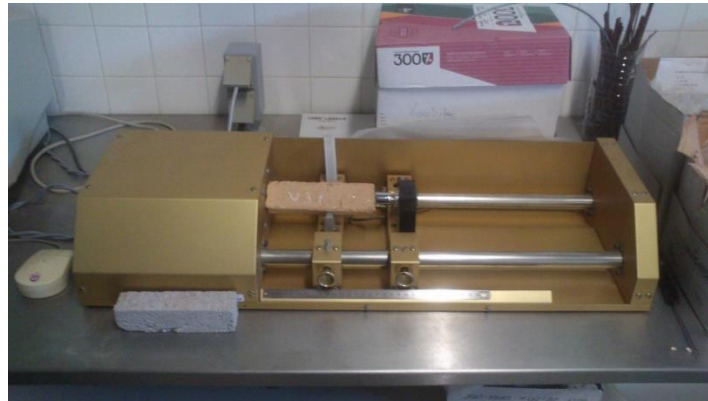
Figura 3.9 - Equipamento “ZEUS Resonance Meter” e provete em ensaio
