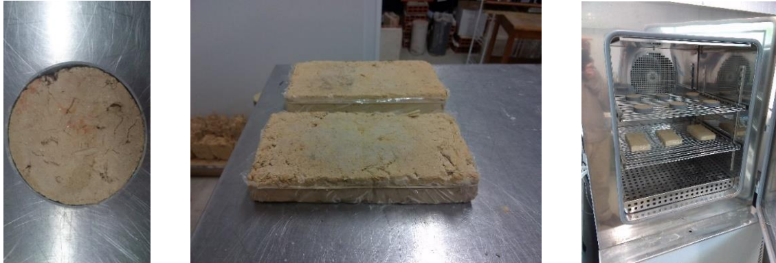
Figura 3.21 - Provetes da tipologia 1 (à esquerda) e da tipologia 2 (ao centro); provetes na câmara climática para ensaio de adsorção do vapor de água (à direita)
