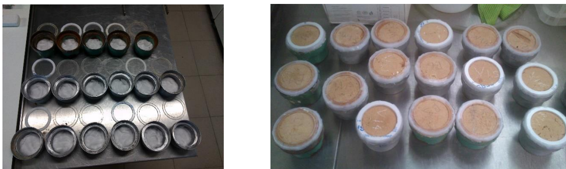
Figura 3.19 - Preparação da cápsula com água e algodão (à esquerda); conjunto de ensaio (à direita)
