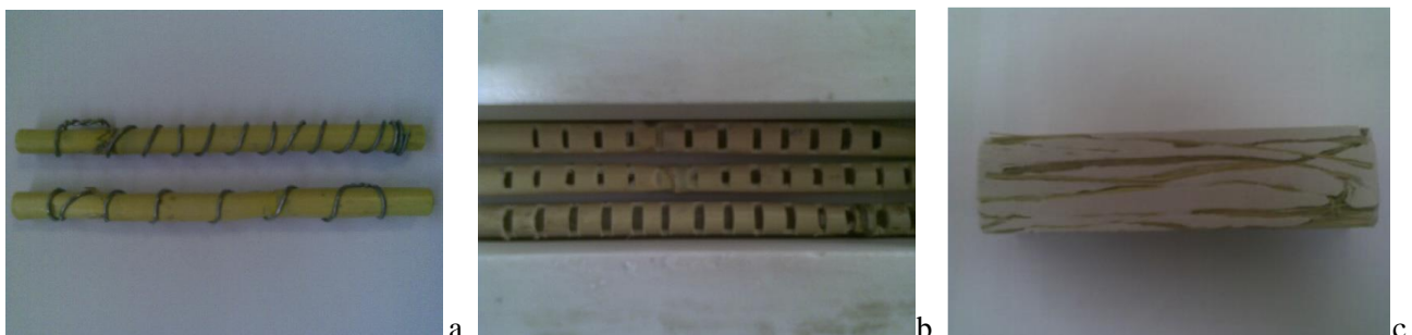
Figura 2.31 - Exemplos de modificações usando canas com 8-10 mm de diâmetro e diferentes arranjos de arame (a), canas com 10-12 mm de diâmetro com ranhuras (b) e incorporação de fibras de esparto na argamassa (c) (Martínez-Gabarrón et al., 2014)
