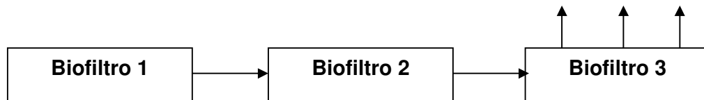
Figura 31 - Associação de biofiltros convencional em serie horizontal.
