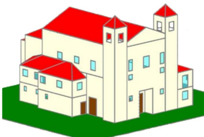
Figura 3.3 - Modelo desenvolvido da Igreja de São Cristóvão, no WUFI®Plus[27]
