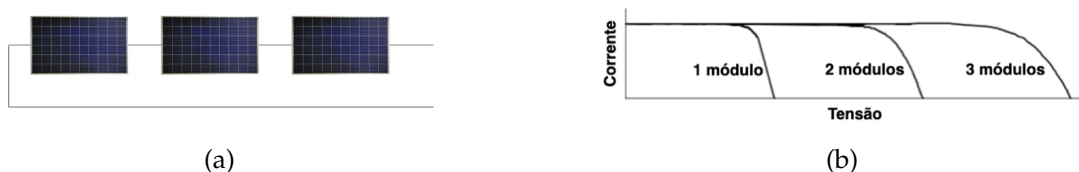
Figura 3.13: (a) Módulos associados em Série (b) Gráfico I-U de módulos associados em série
